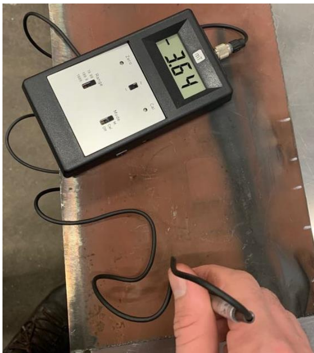
Slika 32. Mjerenje gustoće zaostalog magnetskog polja pomoću Gaussmetra
