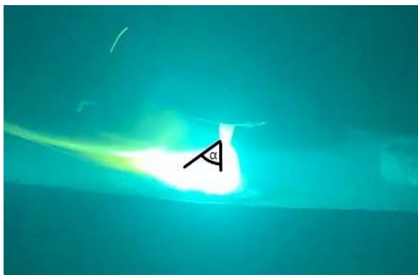
Slika 35. Otklon električnog luka za poziciju 1 (kut \alpha=65^\circ )
