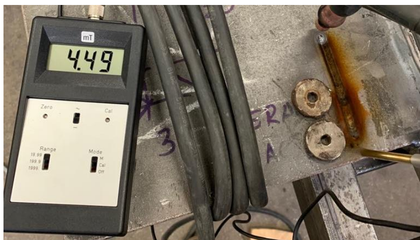
Slika 47. Mjerenje gustoće magnetskog polja na rubu radnog komada u blizini permanentnih magneta
