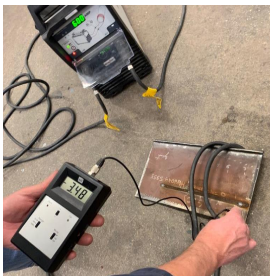
Slika 41. Mjerenje gustoće magnetskog polja za vrijeme demagnetizacije
