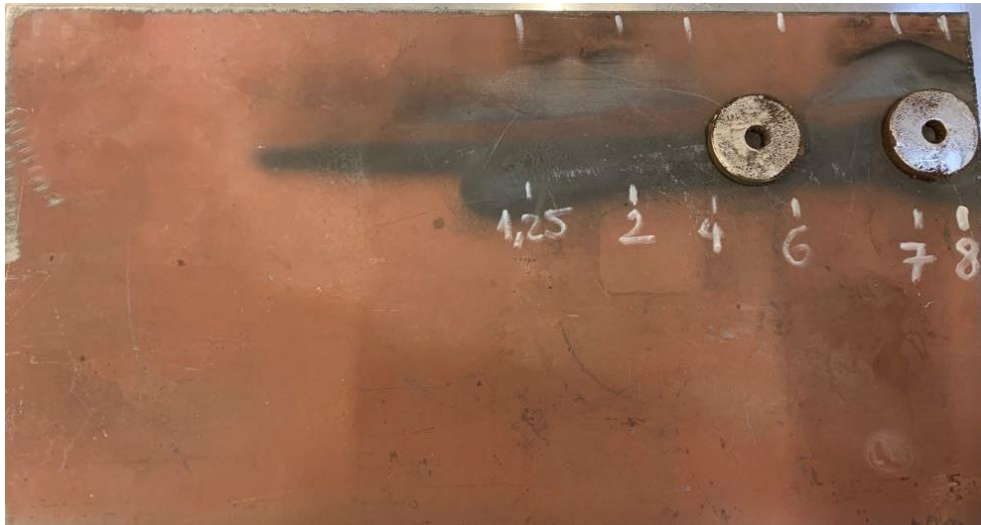
Slika 33. Permanentni magneti postavljeni na radni komad i označene vrijednosti gustoće magnetskog polja uzduž radnog komada
