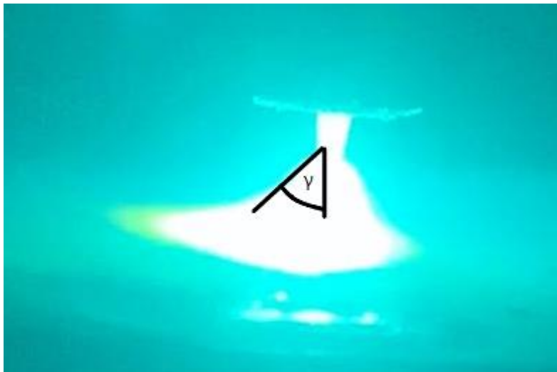
Slika 37. Otklon električnog luka za poziciju 3 (kut \gamma=50^\circ )
