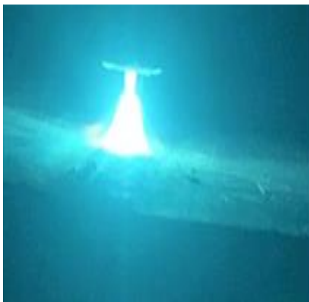
Slika 45. Izgled električnog luka na kraju procesa navarivanja nakon provedene demagnetizacije
