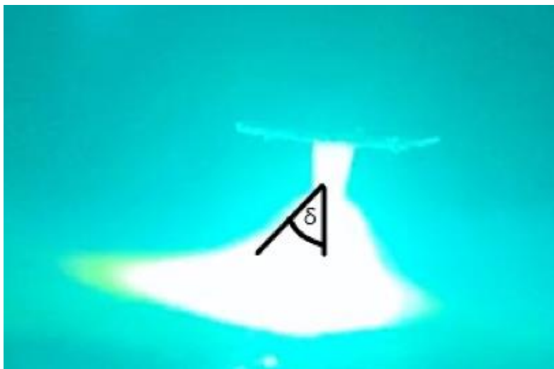
Slika 38. Otklon električnog luka za poziciju 4 (kut \delta=43^\circ )
