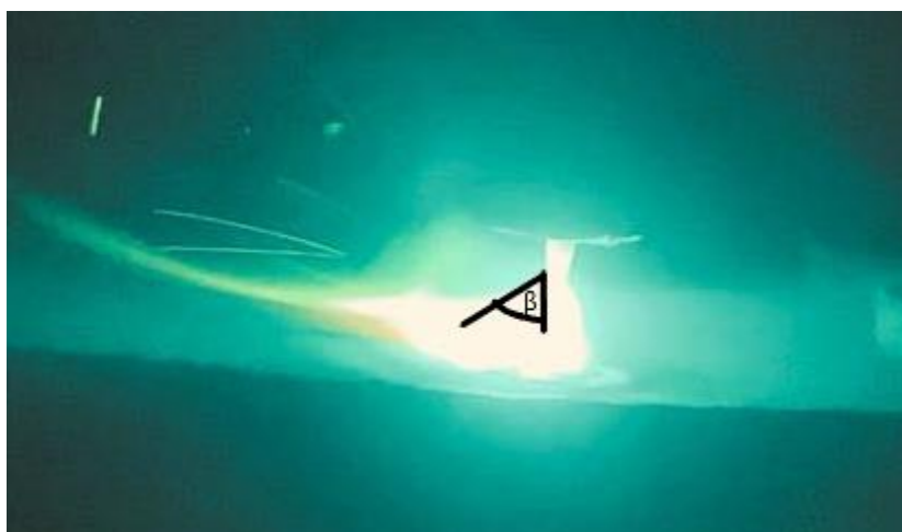
Slika 36. Otklon električnog luka za poziciju 2 (kut \beta=60^\circ )
