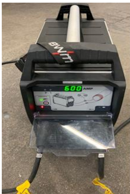
Slika 40. Uređaj za demagnetizaciju „Degauss 600“
