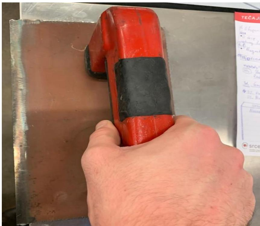
**Slika 29. Provođenje magnetizacije magnetnim jarmom**
