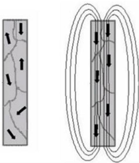
Slika 10. Stanje feromagneta prije izlaganja magnetskom polju (lijevo) i nakon izlaganja magnetskom polju (desno) [7]
