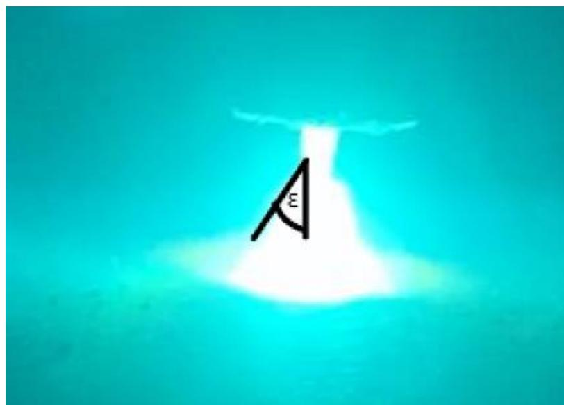
**Slika 39.** Otklon električnog luka za poziciju 5 (kut  $\varepsilon=30^\circ$ )
