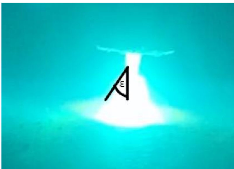
Slika 39. Otklon električnog luka za poziciju 5 (kut \varepsilon=30^\circ )
