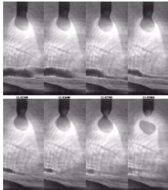
Slika 26. Odvajanje kapljice metala kod MAG postupka zavarivanja [14]
