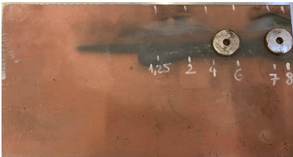
Slika 33. Permanentni magneti postavljeni na radni komad i označene vrijednosti gustoće magnetskog polja uzduž radnog komada
