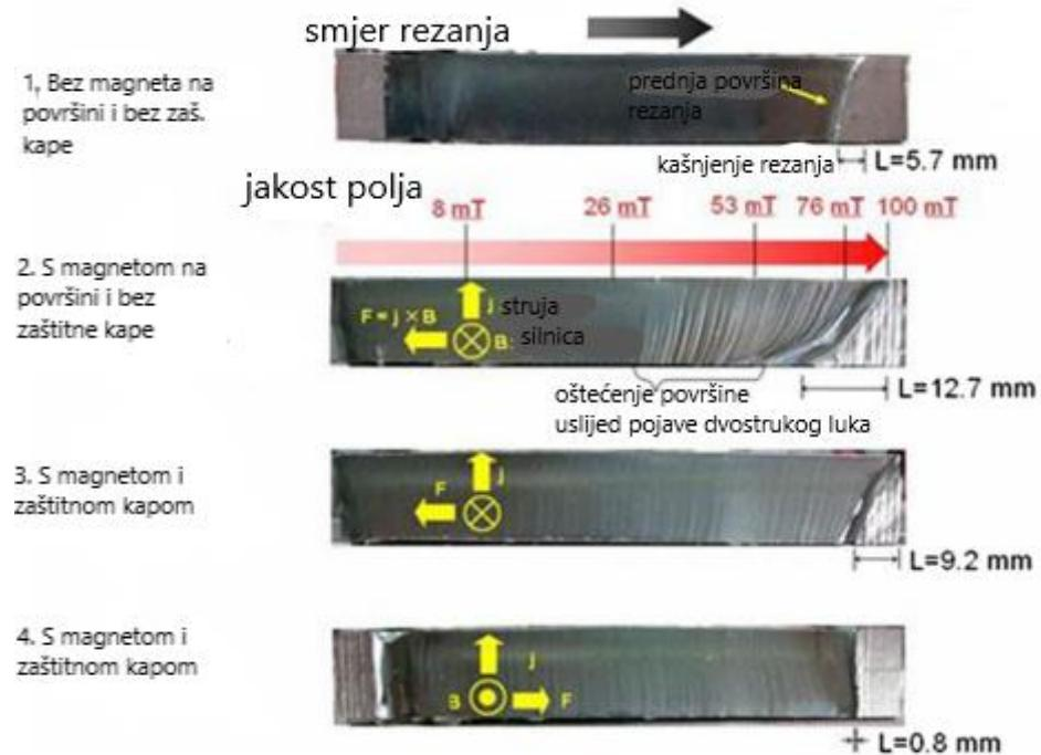
Slika 24. Poprečni presjek ploče prilikom 4 uvjeta rezanja [13]
