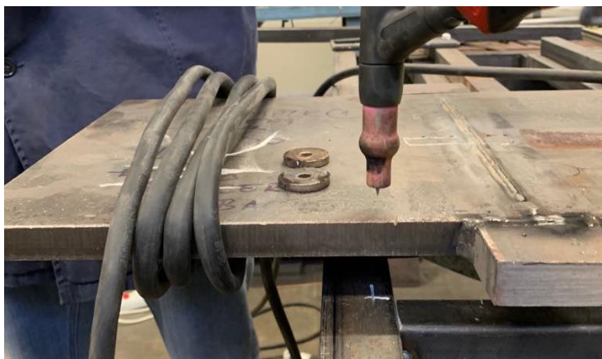
Slika 46. Radni komad s postavljenim permanentnim magnetima i omotanom zavojnicom
