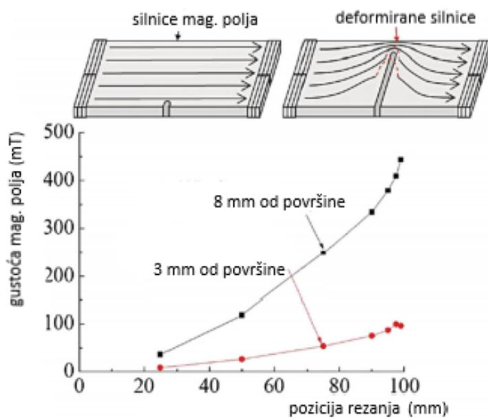
Slika 23. Ovisnost gustoće magnetskog polja o poziciji rezanja [13]
