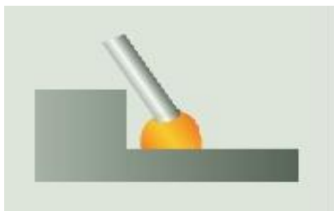
Slika 6. Promjena kuta elektrode kako bi se kompenziralo puhanje električnog luka [4]
