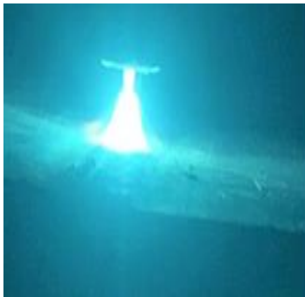
Slika 45. Izgled električnog luka na kraju procesa navarivanja nakon provedene demagnetizacije
