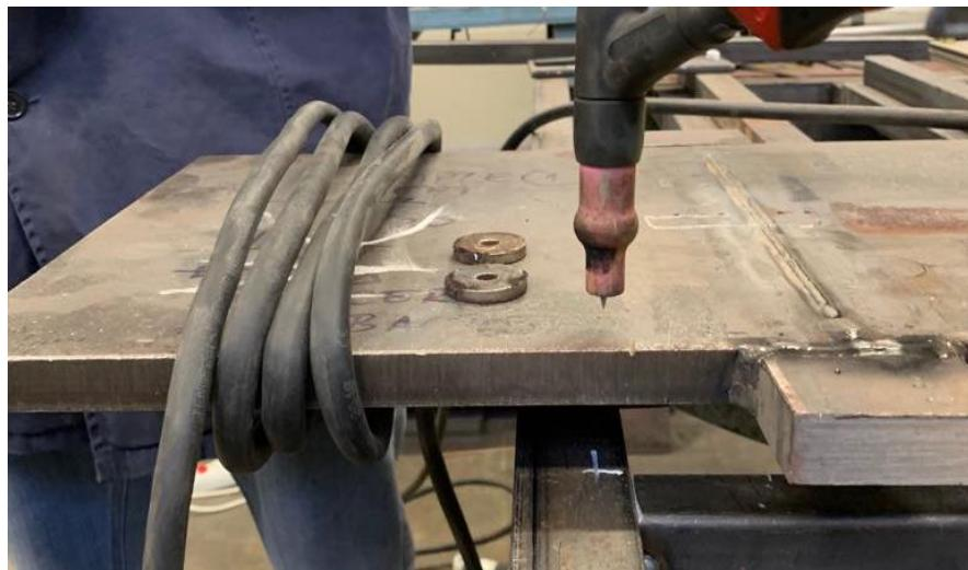
Slika 46. Radni komad s postavljenim permanentnim magnetima i omotanom zavojnicom
