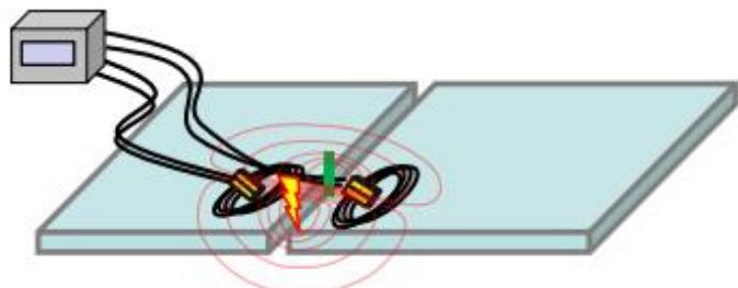
**Slika 19. Kabeli položeni u namotajima na površinu radnog komada [9]**
