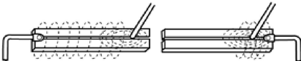
**Slika 8. Dva načina postavljanja priključka struje na radni komad [5]**
