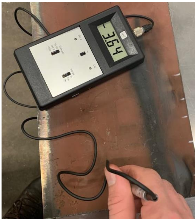
Slika 32. Mjerenje gustoće zaostalog magnetskog polja pomoću Gaussmetra
