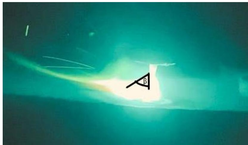
Slika 36. Otklon električnog luka za poziciju 2 (kut  $\beta=60^\circ$ )
