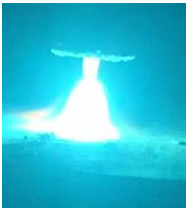
Slika 43. Izgled električnog luka na početku navarivanja poslije provedene demagnetizacije
