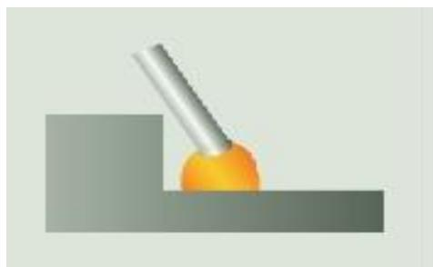
**Slika 6.** Promjena kuta elektrode kako bi se kompenziralo puhanje električnog luka [4]
