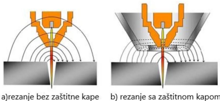
**Slika 25. Mehanizam zaštite feromagnetskom kapom kod plazma rezanja od utjecaja magnetskog polja [13]**
