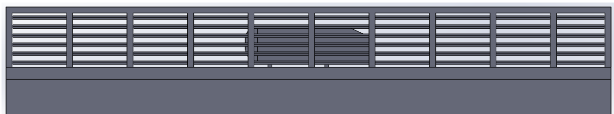
Slika 14. Vjetrobran visine 5 m i poroznosti 50% na mostu s vozilom, pogled iz smjera strujanja
