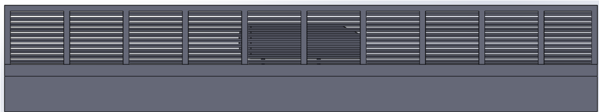
Slika 12. Vjetrobran visine 5 m i poroznosti 30% na mostu s vozilom, pogled iz smjera strujanja
