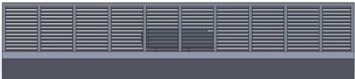
Slika 13. Vjetrobran visine 7 m i poroznosti 30% na mostu s vozilom, pogled iz smjera strujanja
