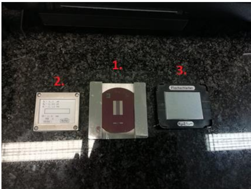
Slika 33. Redoslijed mjerenja etalona
