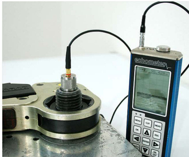
Slika 25. Mjerenje sile u vijku s pomoću ultrazvuka [10]
