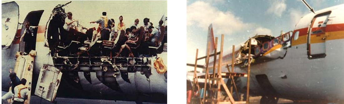
Slika 2.10. Oštećenja na Aloha Airlines 737
