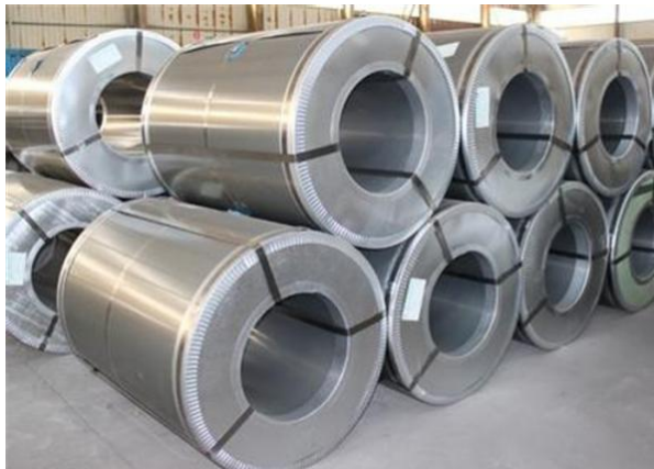
Slika 21. Rola čeličnog transformatorskog lima [24]
