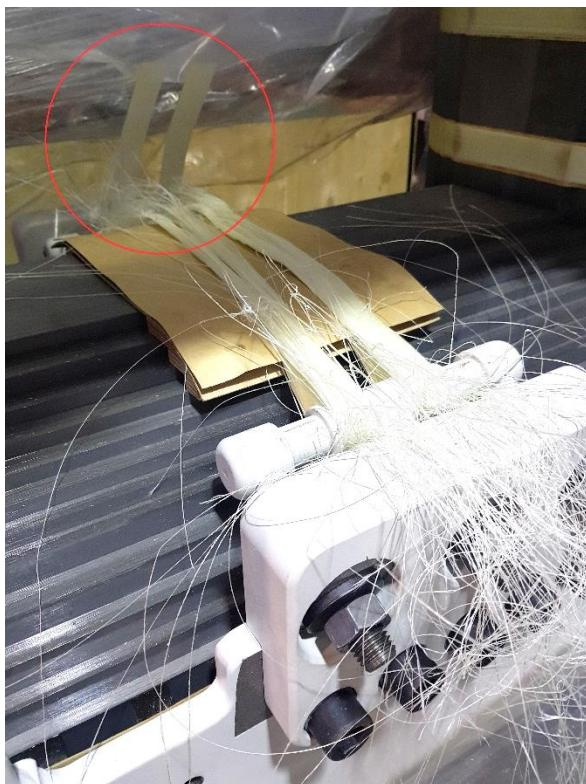
**Slika 68. Odlijepljeni dio trake prilikom ispitivanja na testnoj jezgri**
