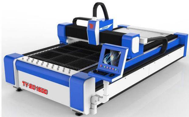
Slika 23. Laserski rezač transformatorskog lima
