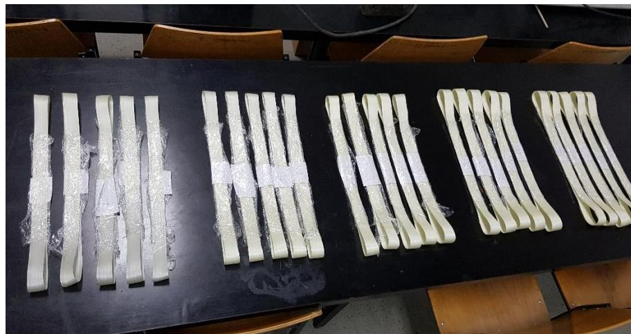
**Slika 49. Uzorci steznih elemenata prije ispitivanja**
