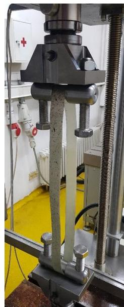
Slika 51. Uzorak pozicioniran na kidalici
