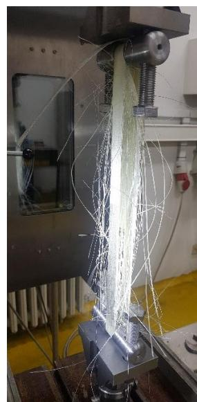
Slika 52. Popuštanje uzorka tijekom ispitivanja
