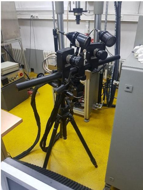
**Slika 53. Mjerni sustav Aramis**
