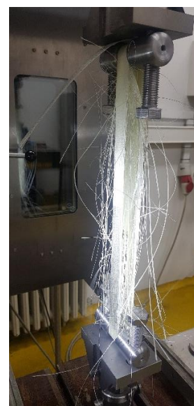
Slika 52. Popuštanje uzorka tijekom ispitivanja
