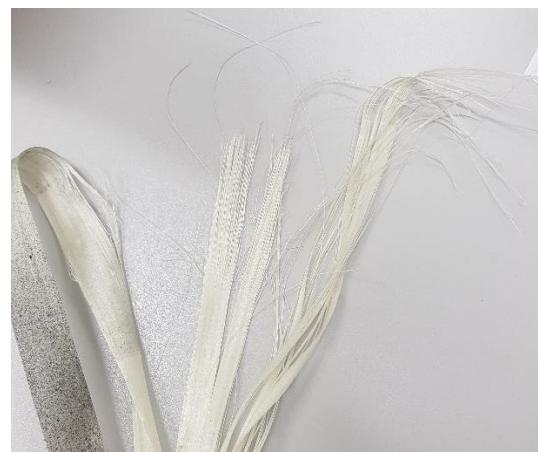
**Slika 82. Puknuće trake s 2 sloja prilikom ispitivanja**
