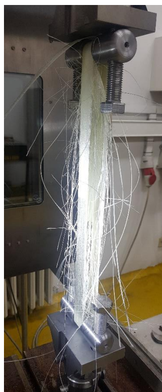
Slika 67. Pucanje vlakana u unutrašnjim slojevima
