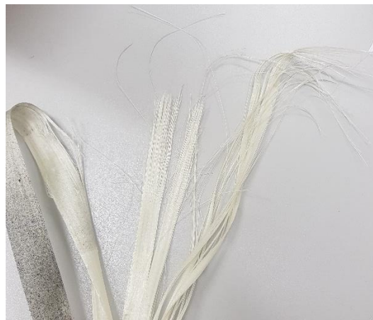
Slika 82. Puknuće trake s 2 sloja prilikom ispitivanja
