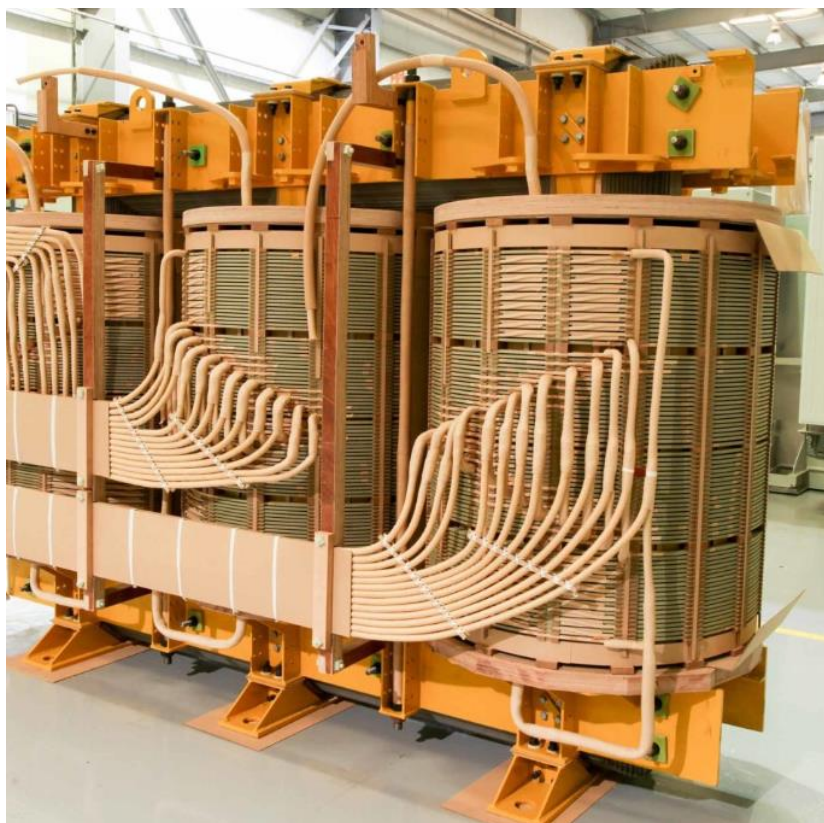
Slika 28. Sklop jezgre i namota u stanju spremnom za ugradnju [29]
