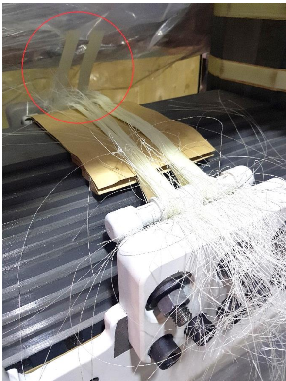
Slika 68. Odljepljeni dio trake prilikom ispitivanja na testnoj jezgri
