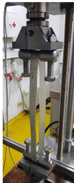
Slika 51. Uzorak pozicioniran na kidalici
