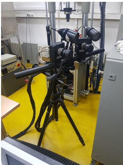
Slika 53. Mjerni sustav Aramis
