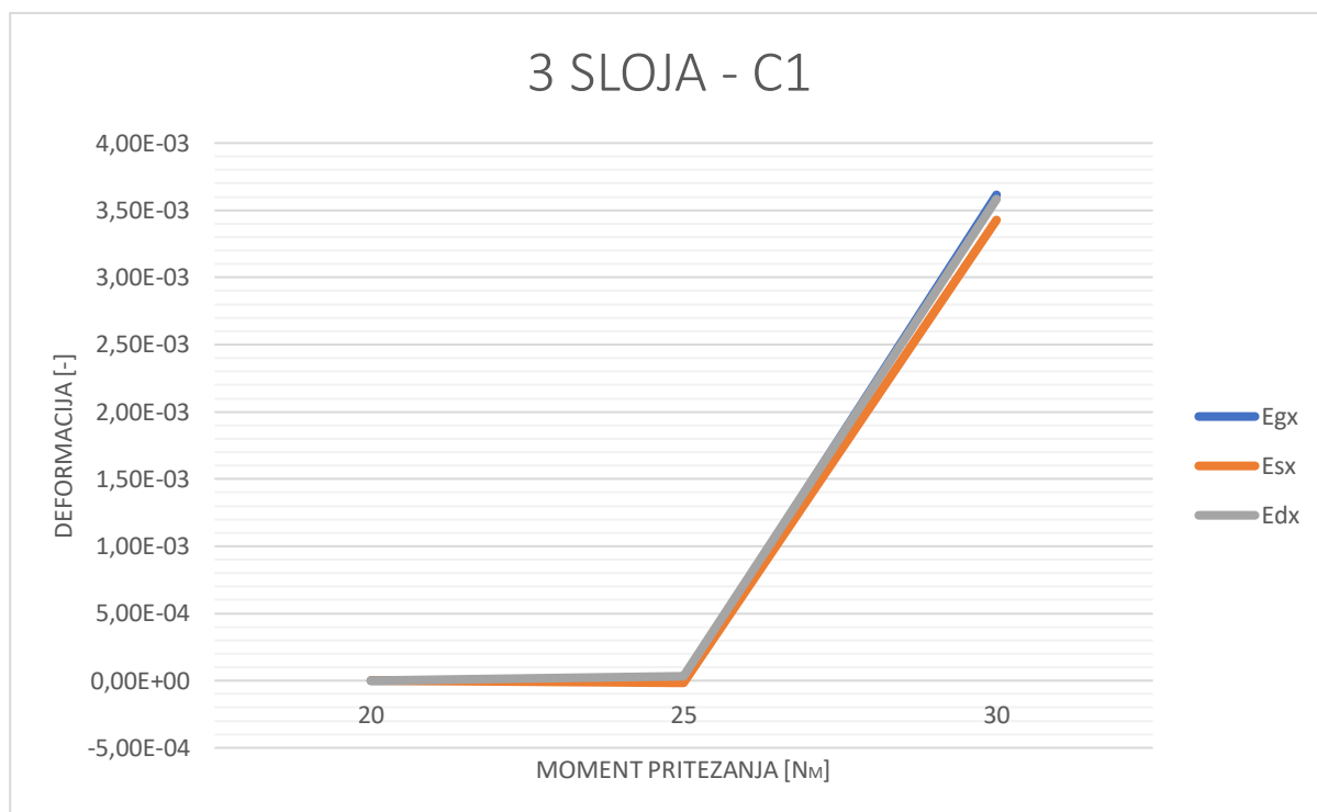
Slika 87. Deformacije steznog elementa s 3 sloja na mjernom mjestu C1
