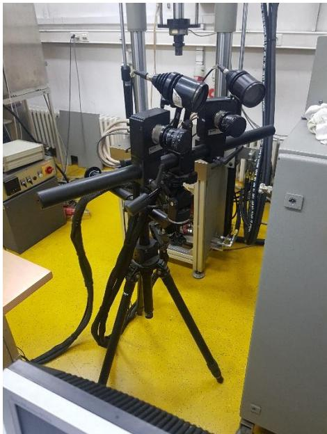
**Slika 53. Mjerni sustav Aramis**
