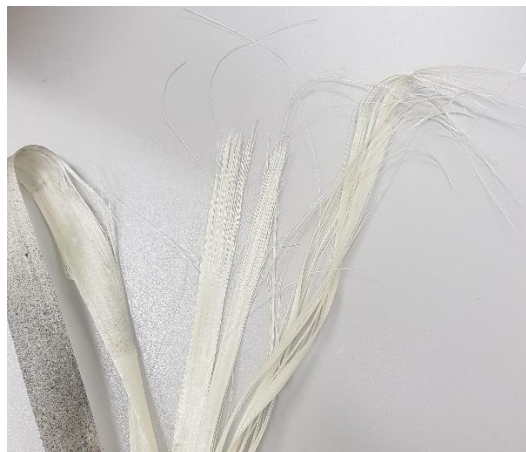
Slika 82. Puknuće trake s 2 sloja prilikom ispitivanja
