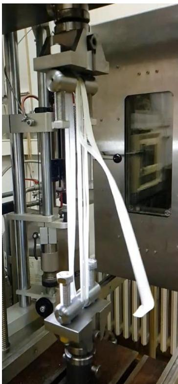
Slika 66. Odljepljivanje trake
