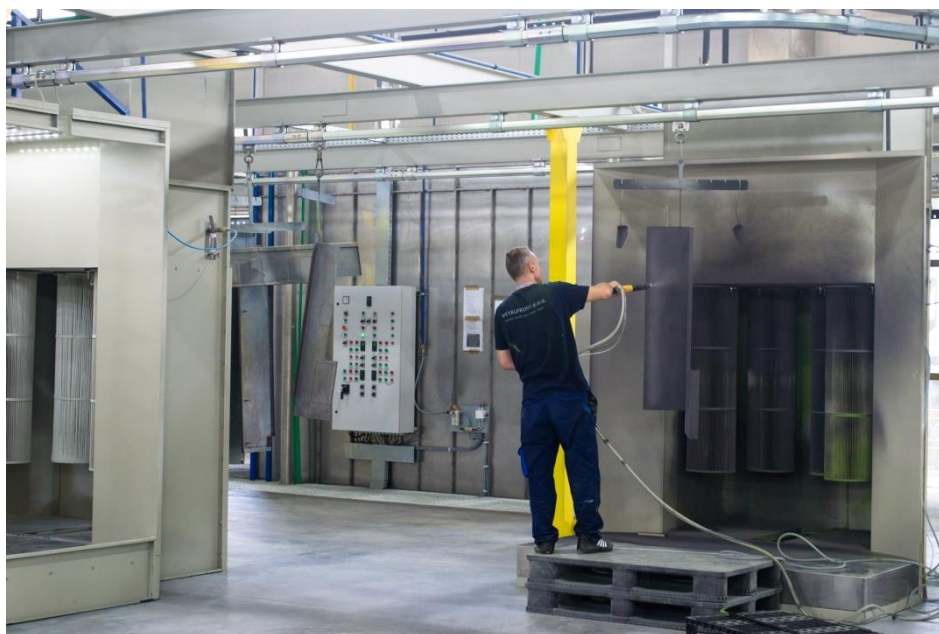
Slika 31. Operacija nanošenja boje i premaza [22]
