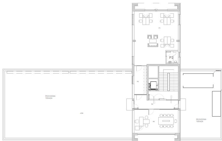
Slika 3.4 Tlocrt drugog kata
