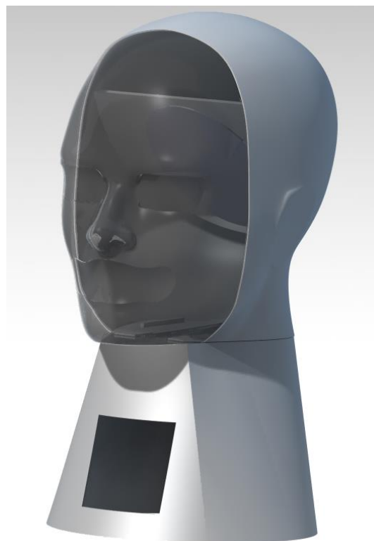
Slika 93. Sklop druge verzije glave afektivnog robota
