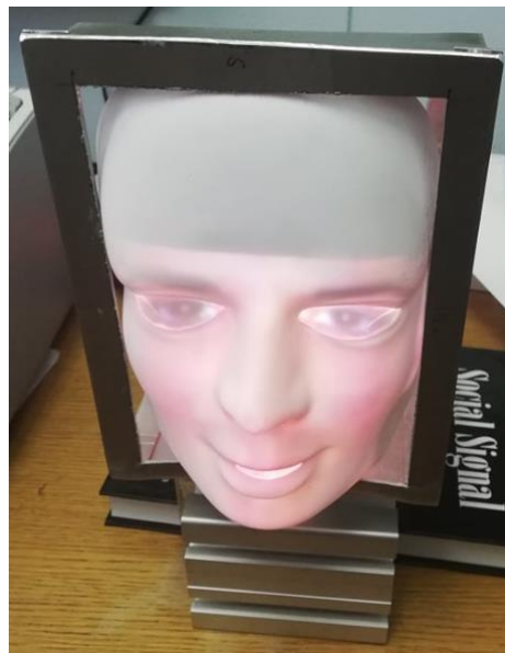
Slika 31. Glava afektivnog robota s maskom kao projekcijskom površinom
