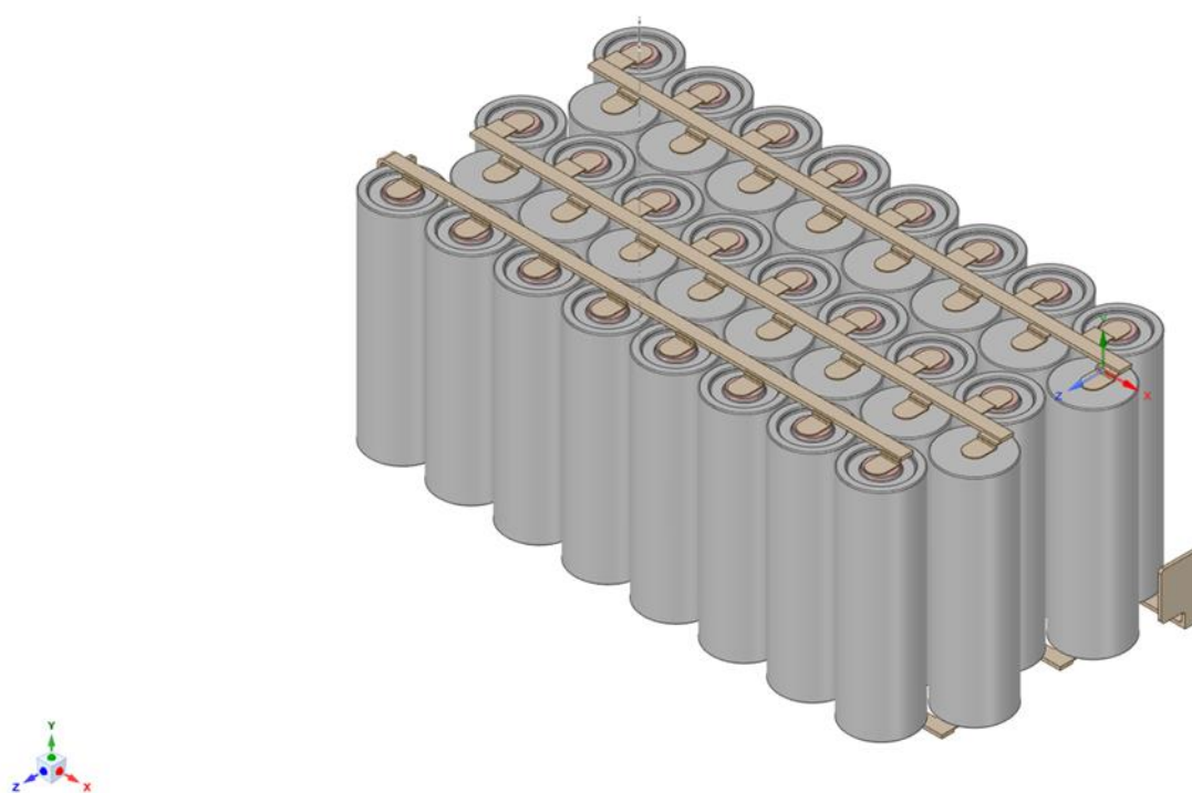
Slika 4.3 Serijski i paralelni spoj ćelija u modulu
