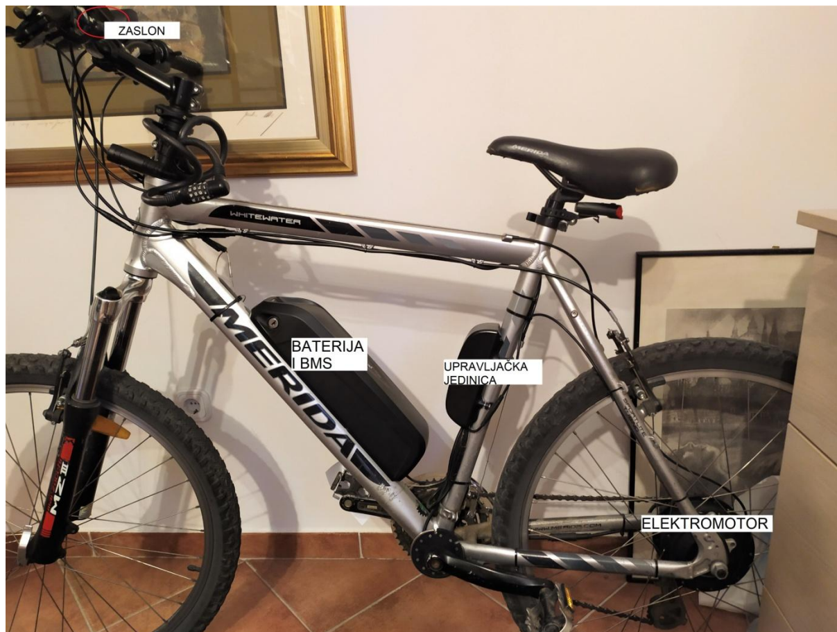
Slika 12. E-bicikl s komponentama električnog sklopa
