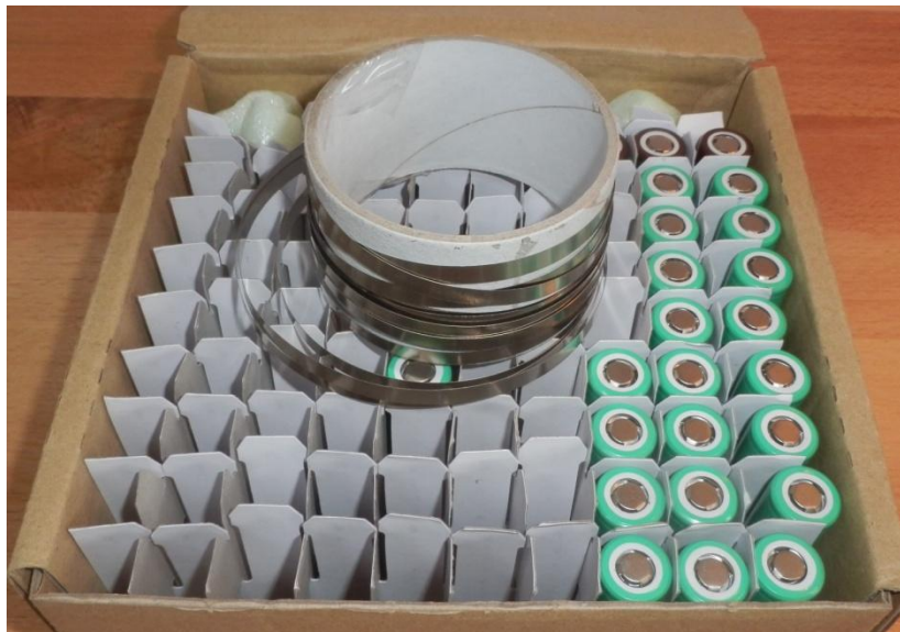
Slika 14. Litij-ionske ćelije i traka za spajanje
