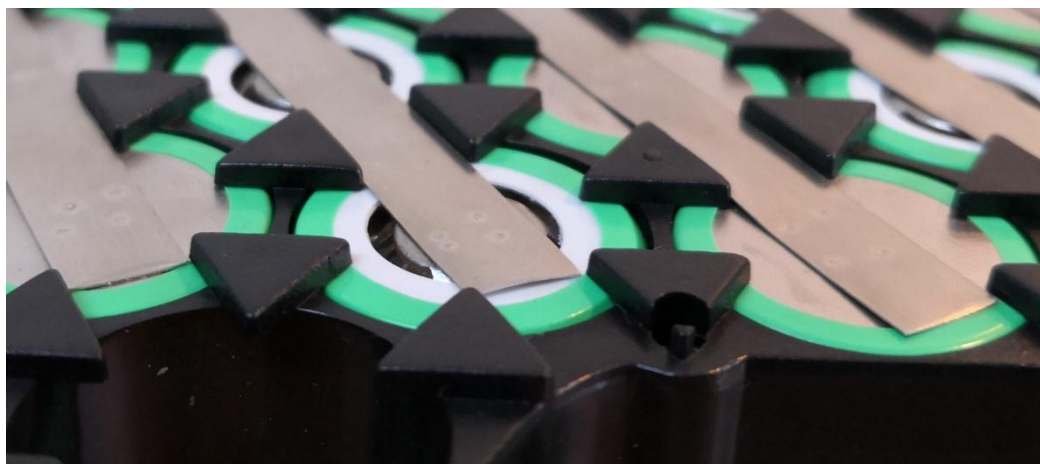
Slika 22. Detalj tvrdog spajanja mrežice i ćelija
