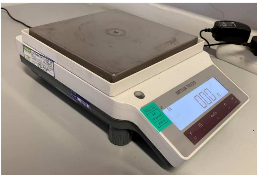
Slika 48. Precizna vaga za mjerenje razlike mase tarne ploče
