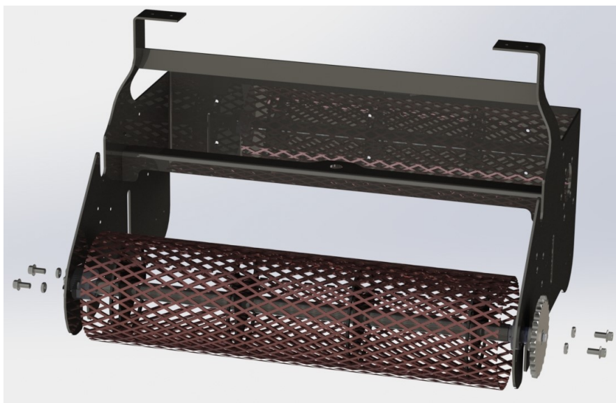
Slika 8.1: Montaža pogonskog valjka
