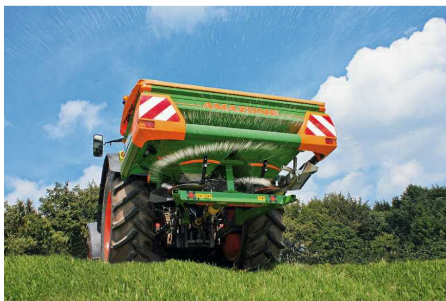
Slika 2.3: Centrifugalni raspršivač sjemena
