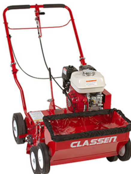
Slika 2.2: Samokretna sijačica pogonjena motorom na unutarnje izgaranje
