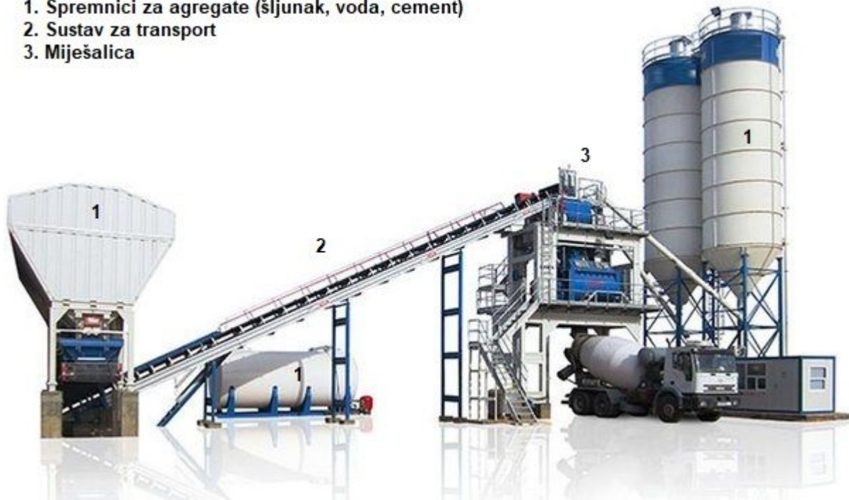
Slika 2. Betonara sa rednim silosima
