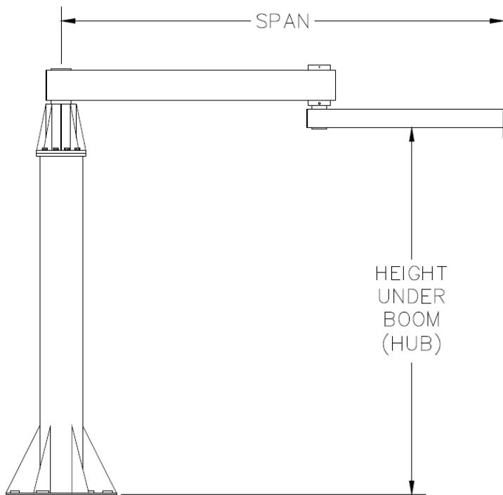
Slika 2: Okretni dohvativnik s horizontalnim preklapanjem (1) [3]
