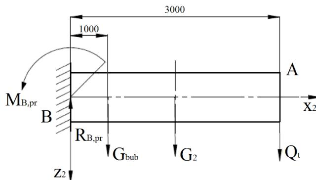
**Slika 33. Opterećenje sekundarnog nosača za slučaj prekopljenog dohvavnika**
