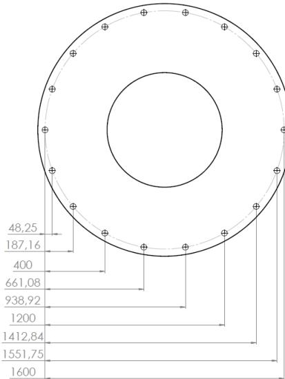
**Slika 47. Geometrija i opterećenje temeljne ploče dohvavnika**
