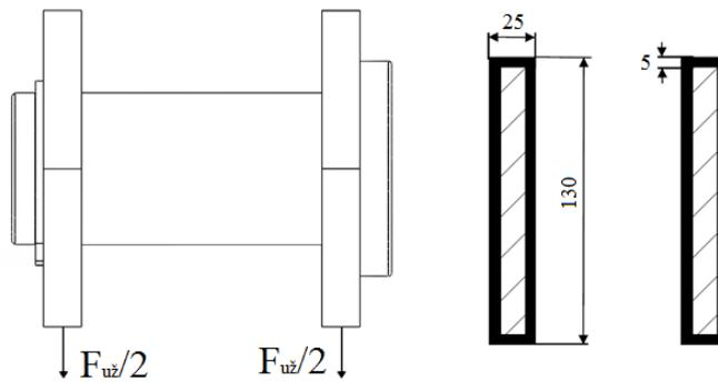
Slika 20. Opterećenje (lijevo) i presjek zavara na mjestu spoja sa sekundarnim nosačem
