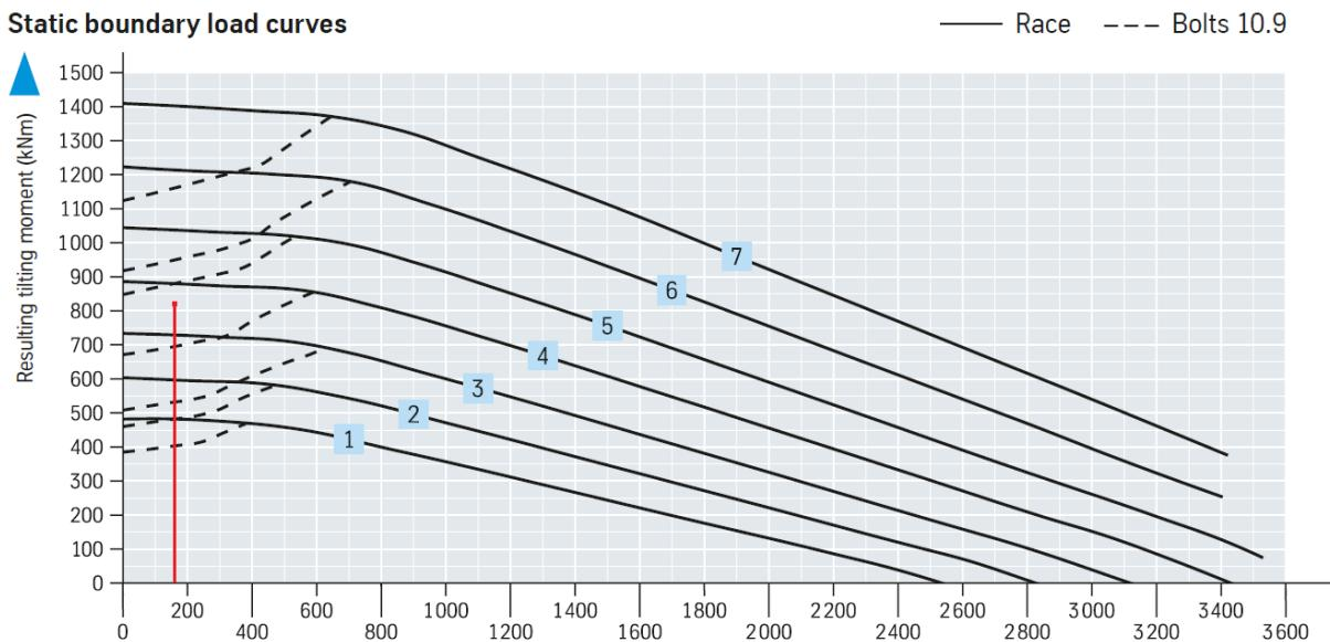
Slika 51. Dopušteno ekvivalentno opterećenje odabranog okretnog ležaja [11]
