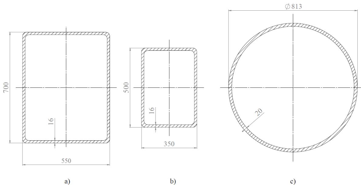
**Slika 26. Dimenziije nosivih profila: a) primarni, b) sekundarni, c) stup**
