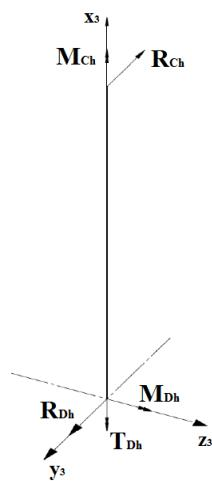
**Slika 45. Opterećenje nosivog stupa izazvano inercijskim silama elemenata konstrukcije**
