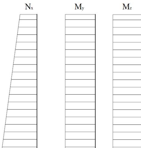
**Slika 38. Raspodjela unutarnjih sila i momenata nosivog stupa za slučaj preklopljenog dohvavnika**
