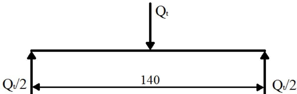
Slika 18. Opterećenje osovine užnice
