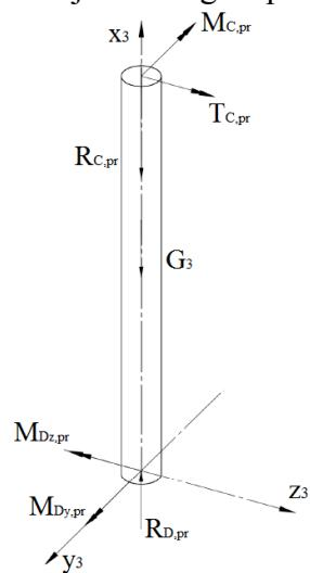
**Slika 37.** Opterećenje nosivog stupa za slučaj preklopljenog dohvavnika
