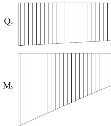
**Slika 36.** Raspodjela unutarnjih sila i momenata na primarnom nosaču za slučaj preklopljenog dohvavnika
