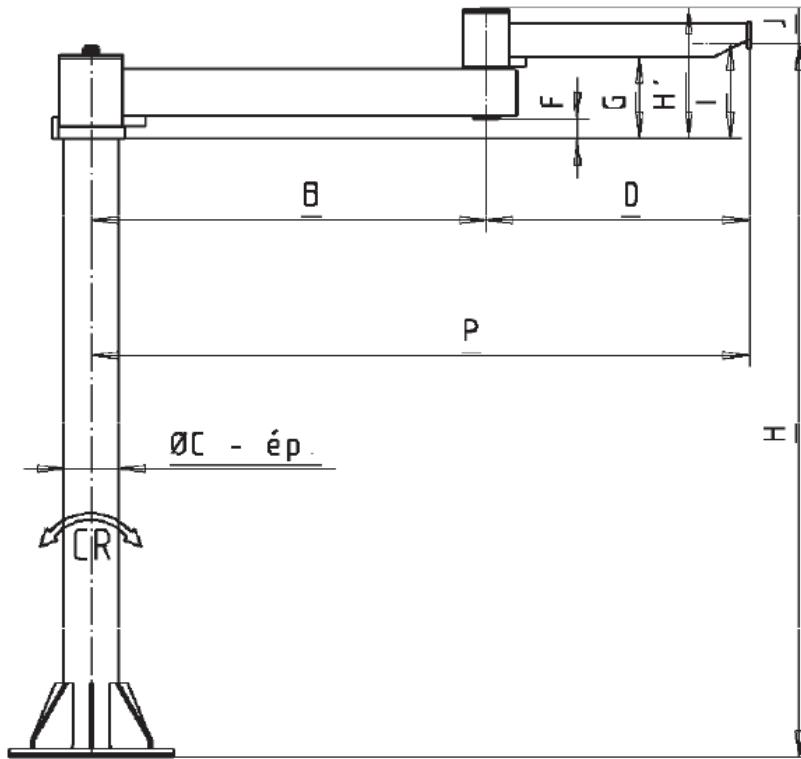
**Slika 3: Okretni dohvatznik s horizontalnim preklapanjem (2) [2]**
