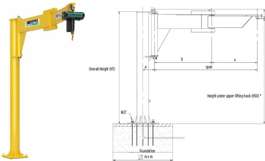
**Slika 4:** Okretni dohvativnik s horizontalnim preklapanjem (3) [2]
