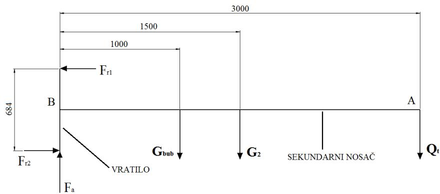
Slika 48. Prijenos opterećenja sa sekundarnog na primarni nosač
