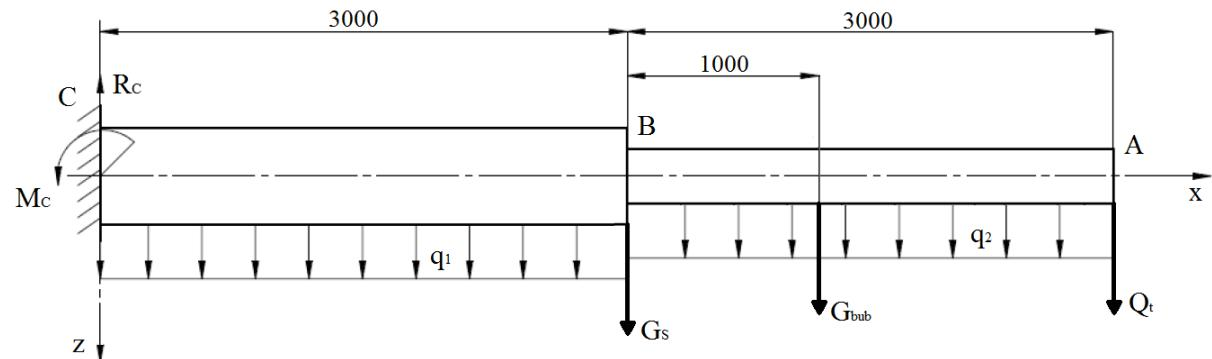
**Slika 28.** Opterećenje primarnog i sekundarnog nosača za slučaj ispruženog dohvavnika
