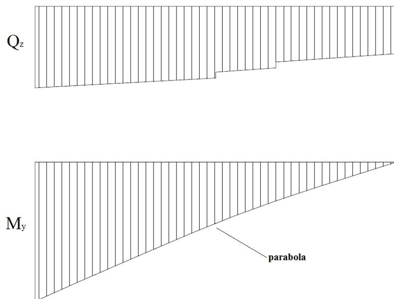
**Slika 29. Raspodjela unutarnjih sila i momenata na primarnom i sekundarnom nosaču za slučaj ispruženog dohvavnika**
