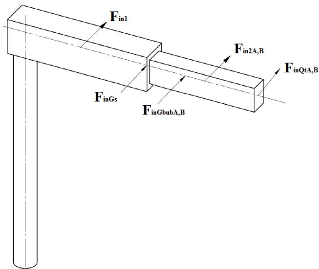
**Slika 40. Sile inercije koje djeluju na nosivu konstrukciju dohvavnika**
