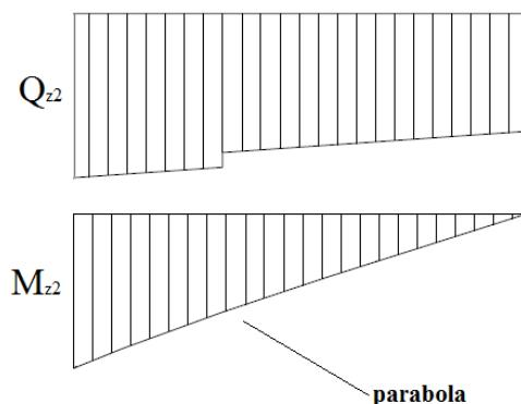
**Slika 34. Raspodjela unutarnjih sila i momenata na sekundarnom nosaču za slučaj prekopljenog dohvavnika**
