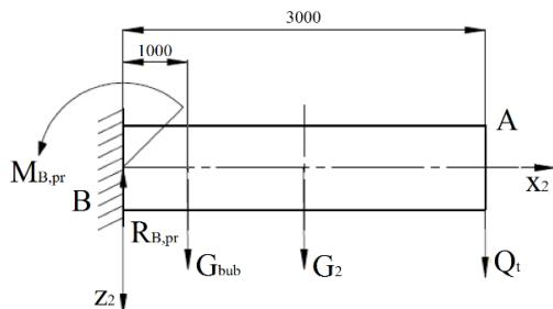
Slika 35. Opterećenje sekundarnog nosača za slučaj prekopljenog dohvavnika
