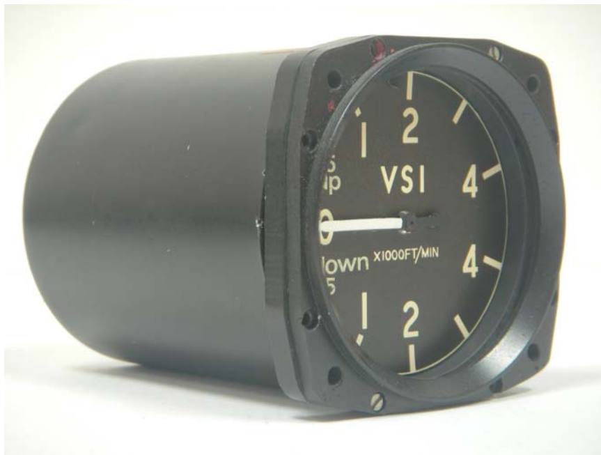
Slika 2.1. Uređaj za mjerenje vertikalne brzine zrakoplova (1000 ft/min~5m/s).
