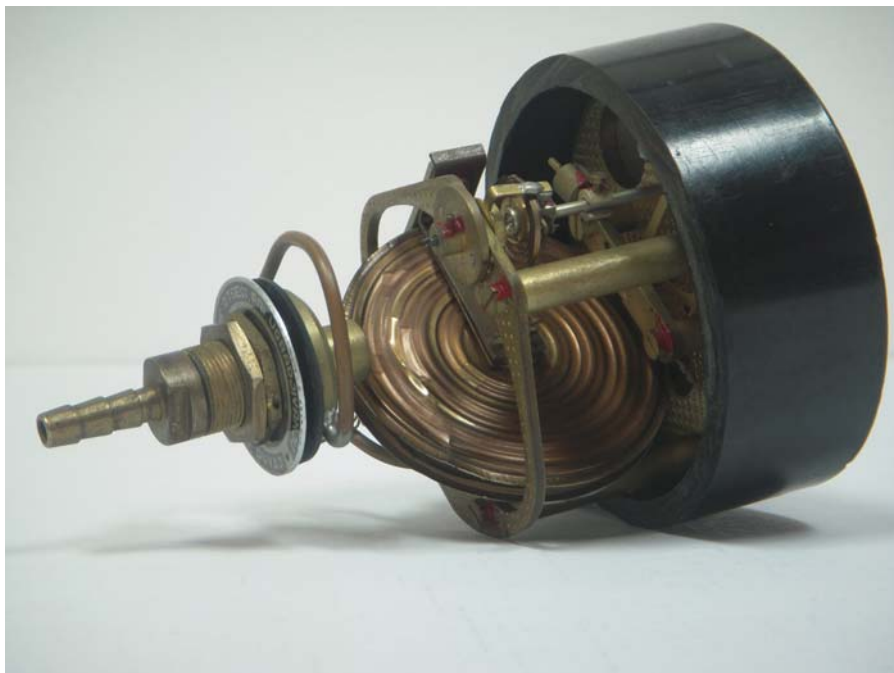
Slika 2.9. Variometar s piezokeramikom, promjer kućišta 70 mm.
