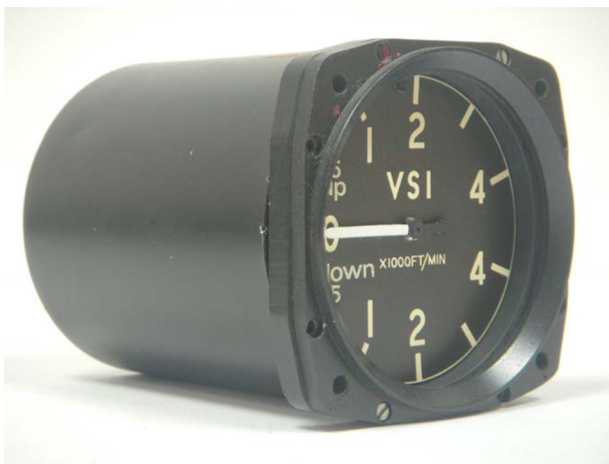
Slika 2.1. Uređaj za mjerenje vertikalne brzine zrakoplova (1000 ft/min~5m/s).
