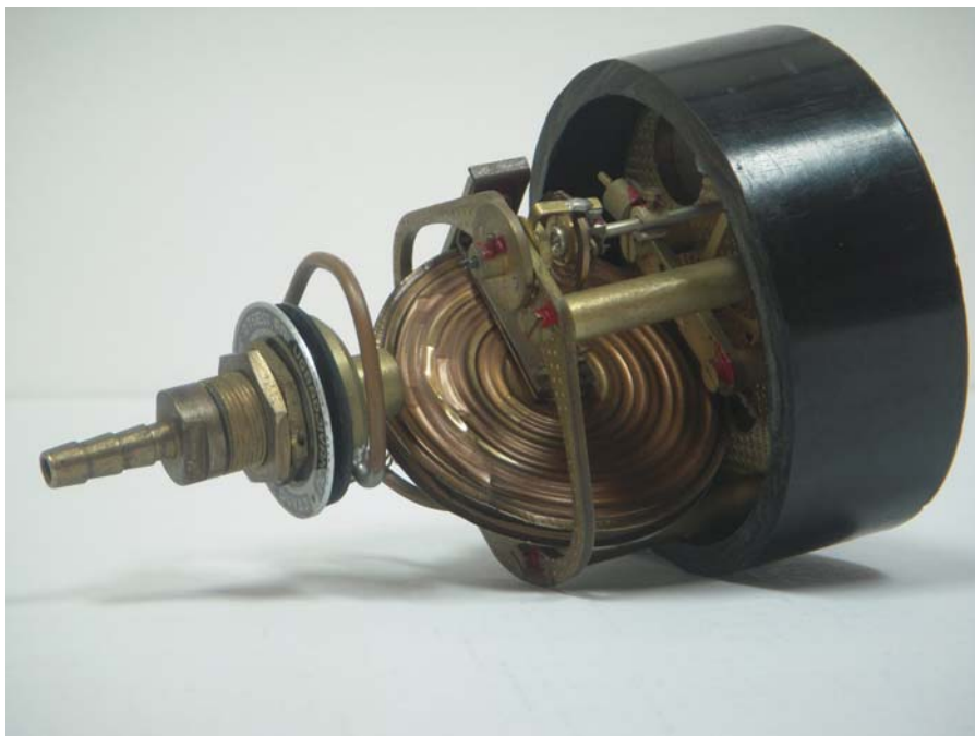
Slika 2.9. Variometar s piezokeramikom, promjer kućišta 70 mm.
