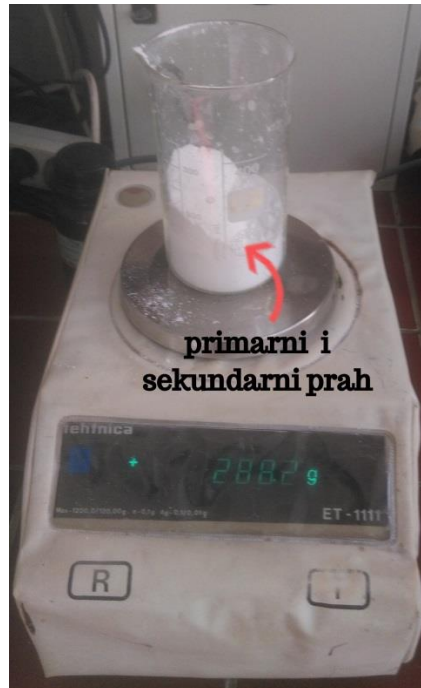
Slika 21. Vaganje primarnog i sekundarnog praha
