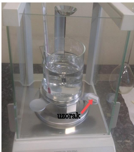
Slika 35. Mjerenje mase uzorka na zraku
