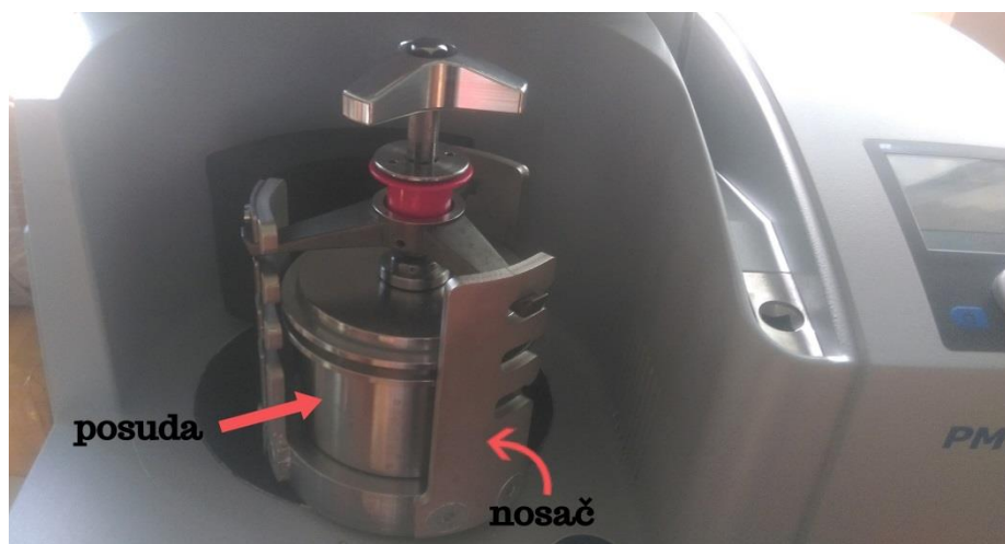
Slika 23. Mljevenje u kugličnom mlinu
