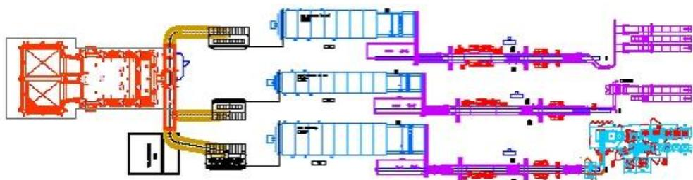
Slika 23. Shema steklarške peći
