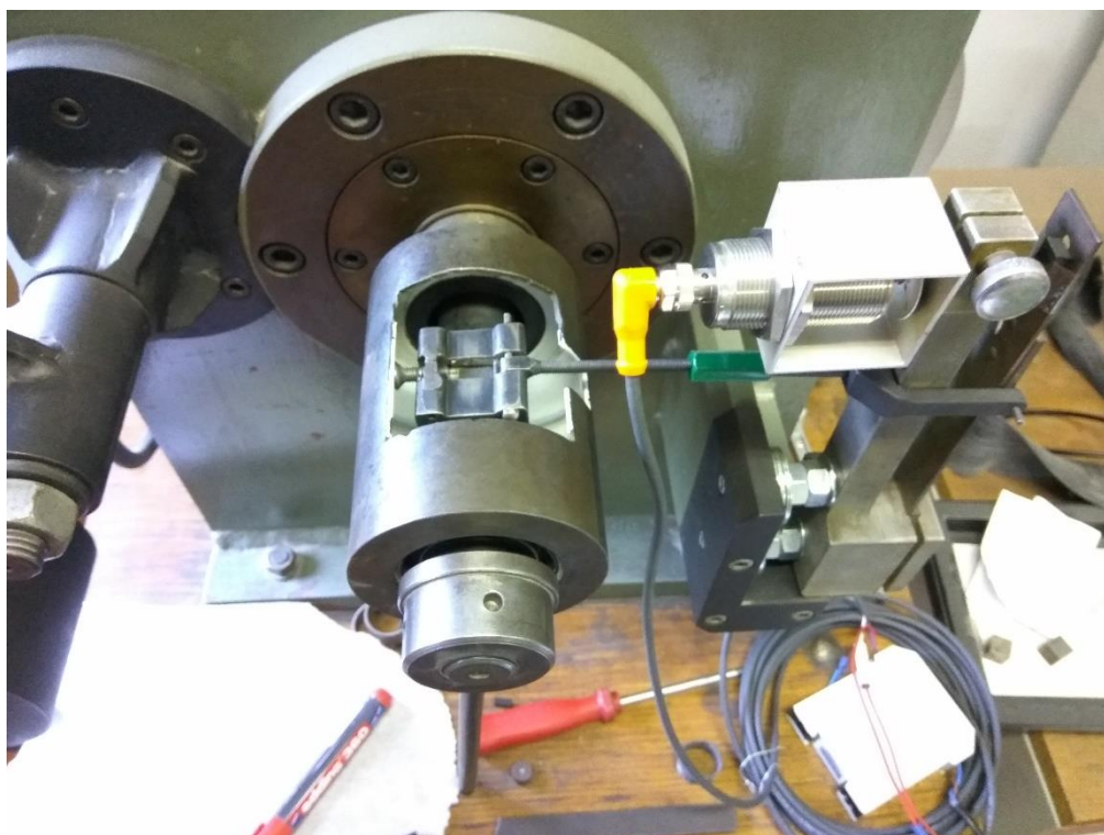
Slika 5.3 Uređaj za ispitivanje metodom „prizme na prstenu“ s posudom za ispitivanje trenja uz podmazivanje
