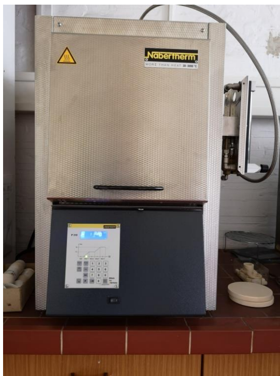
Slika 29. Laboratorijska peč za konvencionalno sinteriranje
