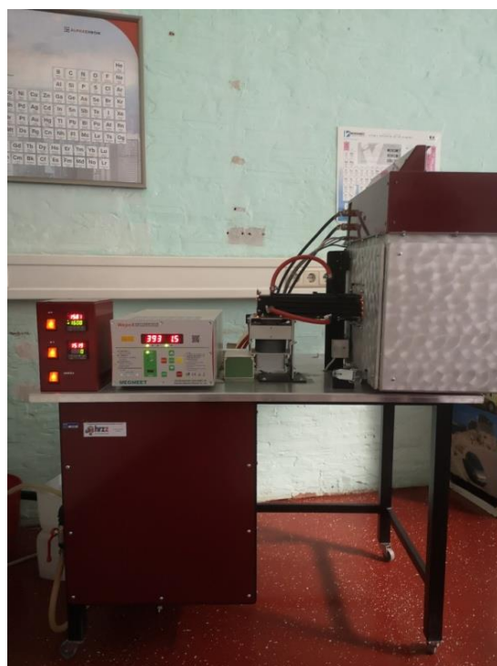
Slika 30. Hibridna peč koja kombinira mikrovalno i konvencionalno zagrijavanje uzoraka
