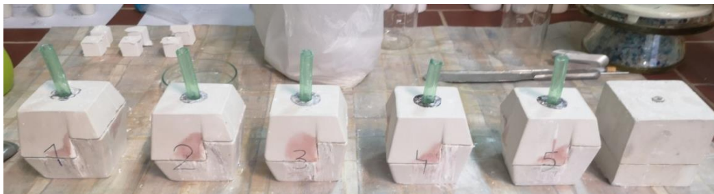
Slika 25. Gipsani kalupi za lijevanje suspenzije
