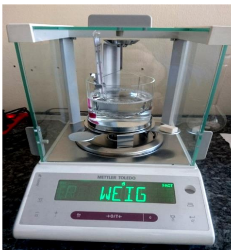
Slika 35. Mjerenje mase uzorka \text{Al}_2\text{O}_3 na zraku
