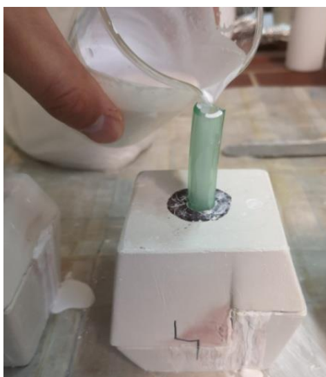
Slika 26. Ulijevanje suspenzije u gipsani kalup
