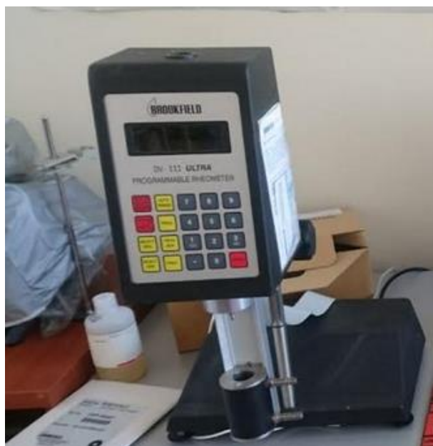
Slika 23. Shematski prikaz rotacijskog viskozimetra Brookfield DV- III Ultra [19]
