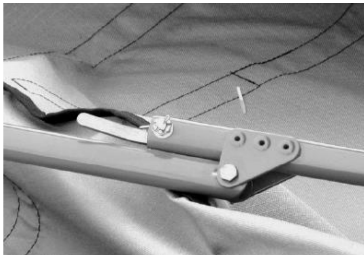
Slika 18. Zglob za sklapanje pomoćnih cijevi stražnjih kotača [9]
