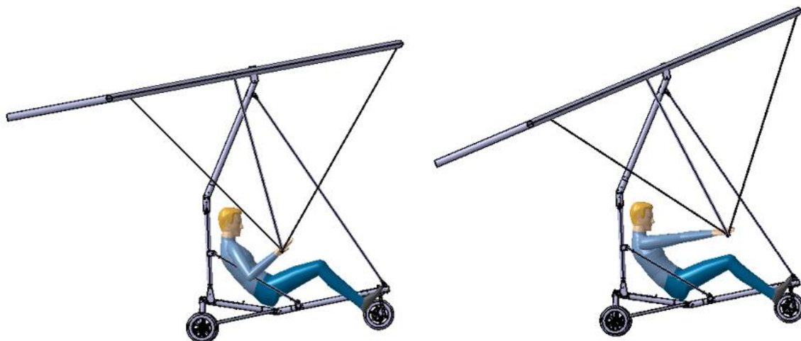
Slika 44. Položaj sjedenja pilota visine 200 cm
