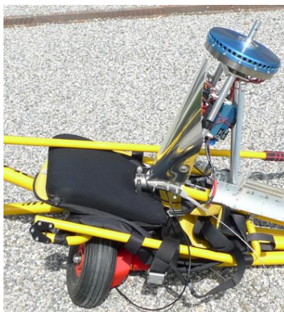
Slika 25. Zglob za sklapanje okvira nosača sjedala [7]
