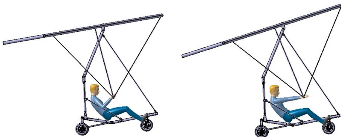
Slika 46. Položaj sjedenja pilota visine 160 cm
