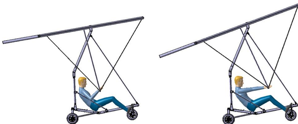
Slika 45. Položaj sjedenja pilota visine 180 cm
