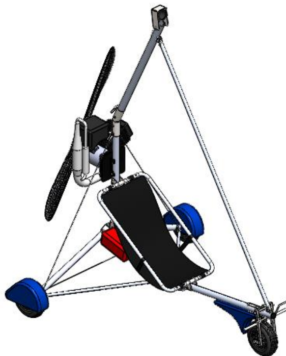
Slika 29. Koncept kolica mikrolake ovjesne jedrilice
