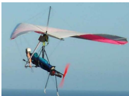
Slika 12. Ležeći položaj kod motorne ovjesne jedrilice [6]
