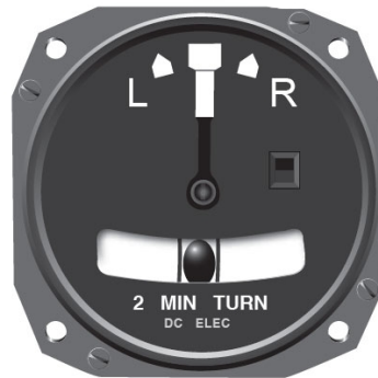
Slika 5.4: Prikaznik klizanja i skretanja
