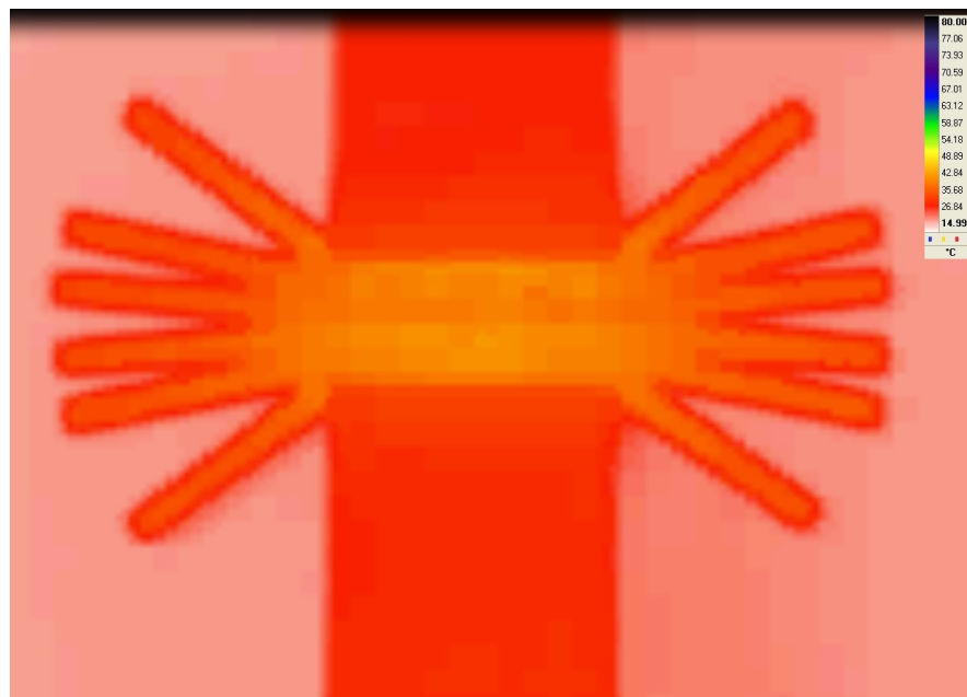
Slika 7.12: Temperatura izmjerena IR kamerom za brzinu deformiranja 50mm/s [9]
