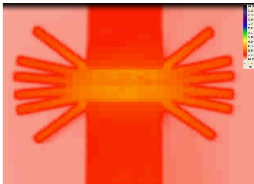
Slika 7.12: Temperatura izmjerena IR kamerom za brzinu deformiranja 50mm/s [9]
