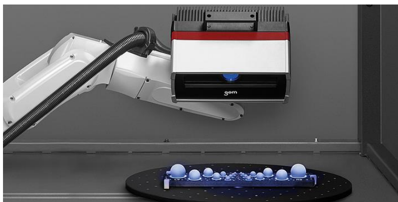
Slika 26. 3D skener Atos tvrtke GOM [46]
