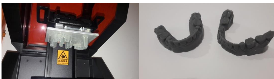
Slika 52. Modeli prije dodatnog umrežavanja (lijevo) i nakon dodatnog umrežavanja (desno)
