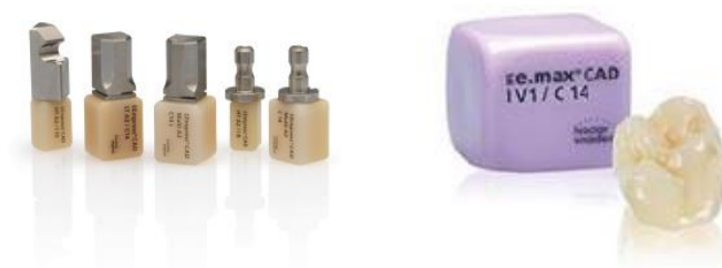
Slika 21. IPS Empress leucitom ojačani staklokeramički blok za CAD-CAM obradu tvrtke Ivoclar Vivadent (lijevo)[39] i litijev disilikatna keramika (IPSe.max, Ivoclar Vivadent) (desno) [32]
