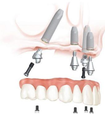
**Slika 53. Principa rada mutli-unit konstrukcije [56]**
