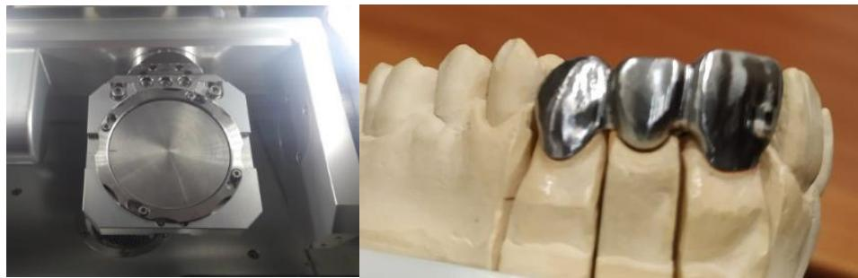
**Slika 48. CoCr disk prije obrade (lijevo) i konačni metalni rad (metalna konstrukcija mosta na koju će se zapeći keramika) (desno)**
