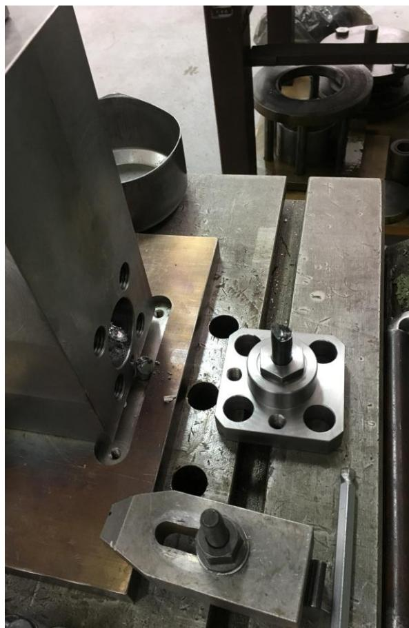
Slika 26. Izbacivanje ECAP-iranih uzoraka iz alata.
