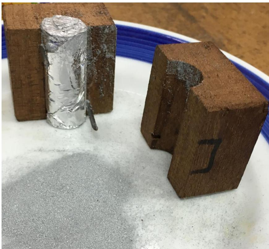
**Slika 19. Prah zamotan u foliju pomoću drvenog kalupa.**
