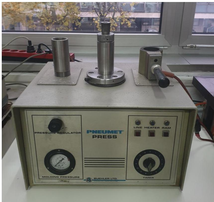
Slika 12. Uređaj za ulijevanje uzorka u polimernu masu.
