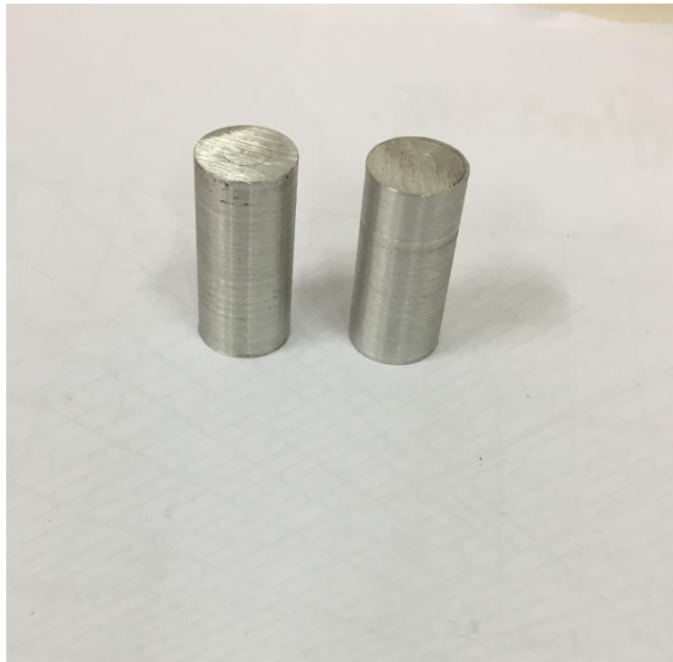
Slika 25. Aluminijski valjčiči za ostvarenje protusile.
