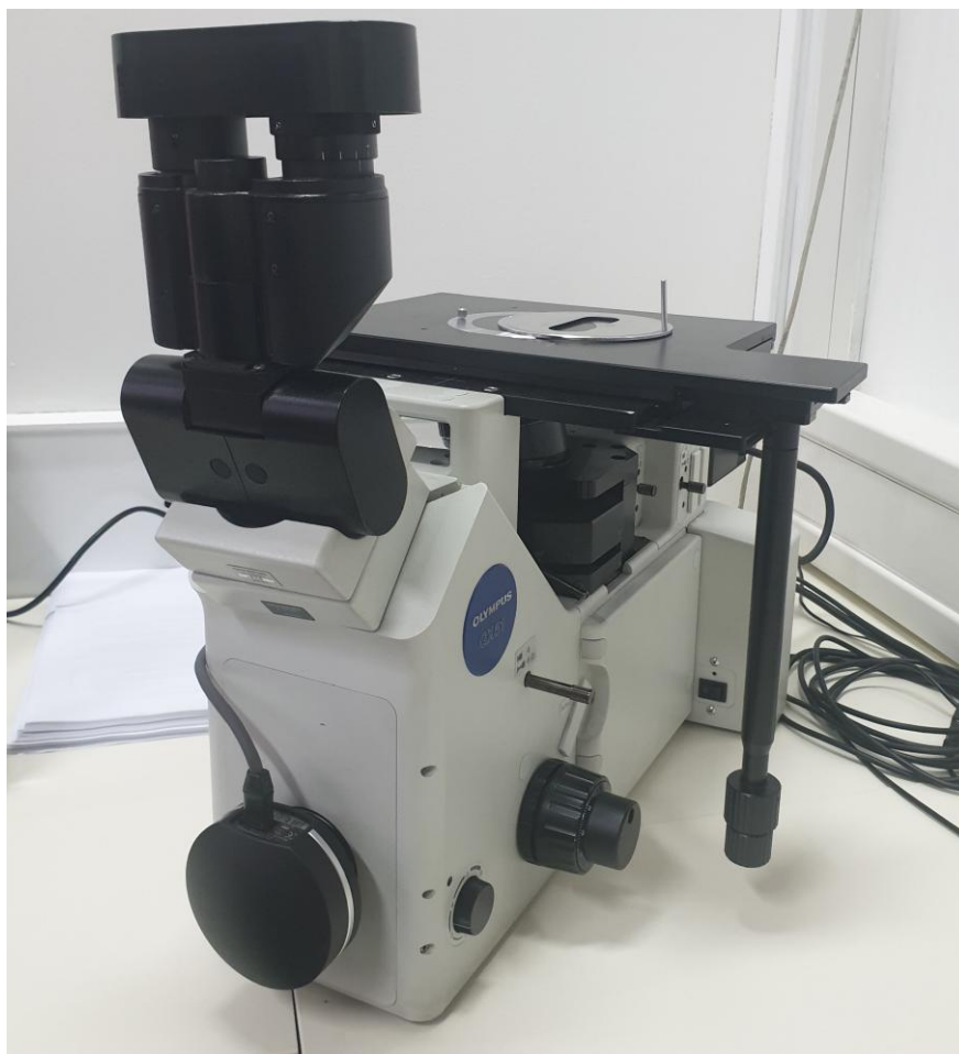
Slika 15. Svjetlosni invertni mikroskop Olympus GX51F-5.
