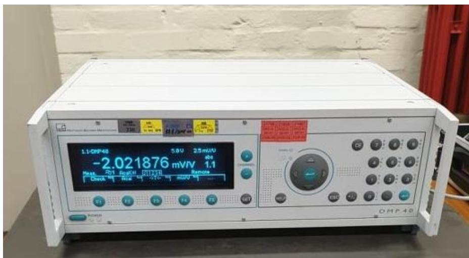
**Slika 20 Mjerno pojačalo DMP40**
