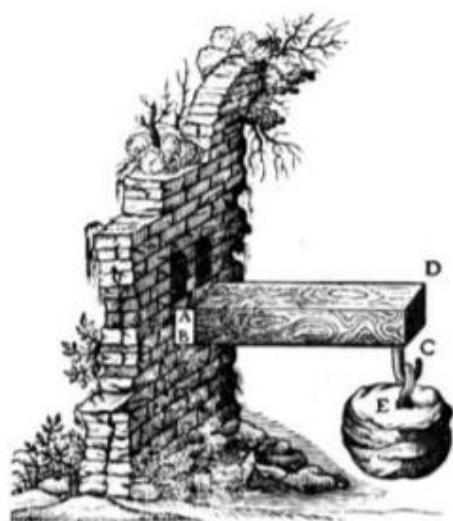
Slika 2 Ispitivanje nosivosti grede (Galileo Galilei) [4]
