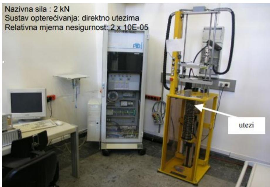
**Slika 3 Nacionalni etalon sile Njemačke u PTB-u [4]**
