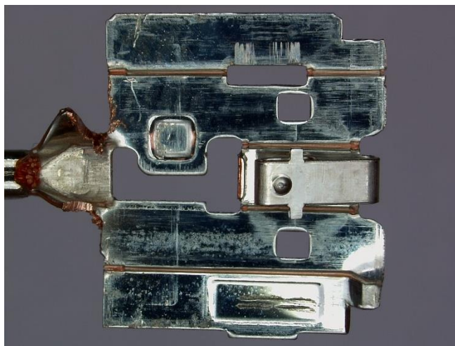
Slika 14. Otvoreni ženski terminal iz jednog dijela
