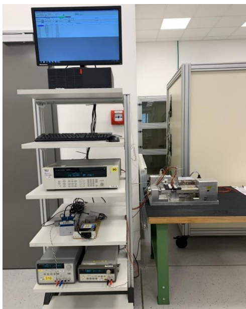
Slika 22. Stanica za fretting ispitivanje
