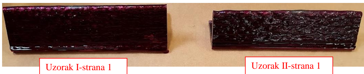
Slika 44. Strana 1 nakon nanošenja penetranta
