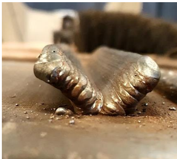
Slika 25. Prikaz problema sa slaganjem profila
