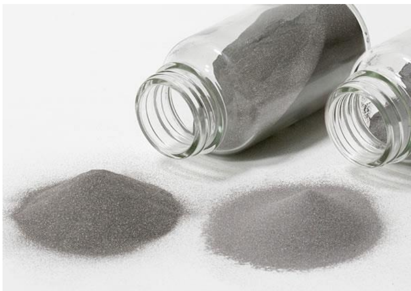
Slika 6. Titanijev prah različite granulacije [7]
