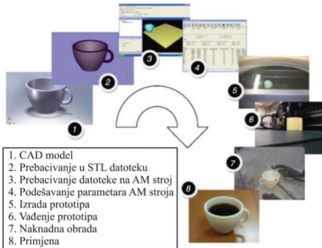
Slika 1. Koraci izrade predmeta aditivnom tehnologijom [2]
