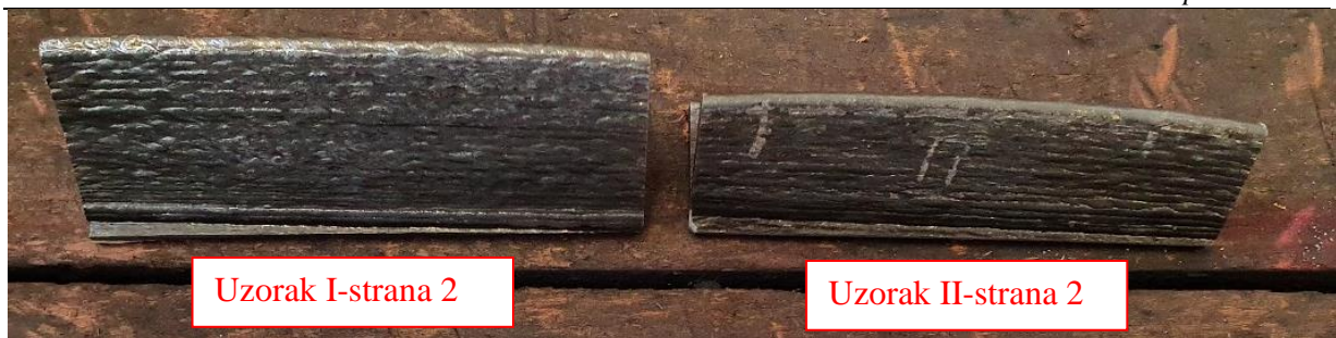
Slika 42. Strane 2 uzoraka nakon čišćenja i prije nanošenja penetranta
