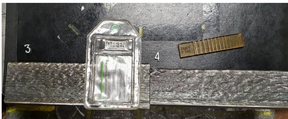
Slika 65. Razmještaj uzoraka I, II i slikovne ploče prije snimanja- prednja strana
