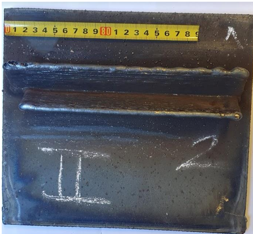
Slika 31. Uzorak 2 prije odvajanja podložne ploče
