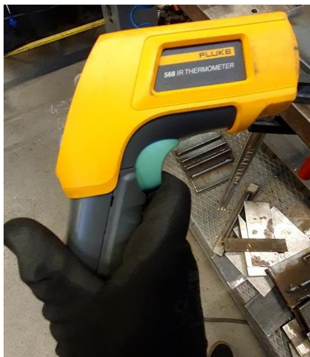
Slika 24. Infracrveni digitalni termometar korišten u eksperimentu
