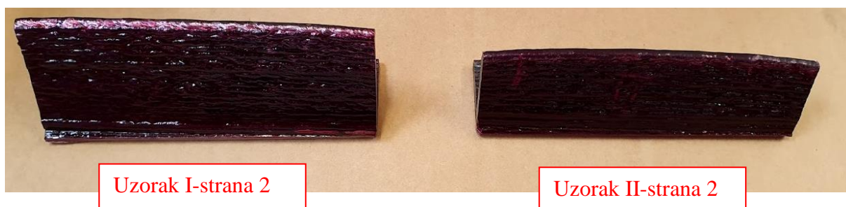
Slika 43. Strane 2 uzoraka nakon nanošenja penetranta
