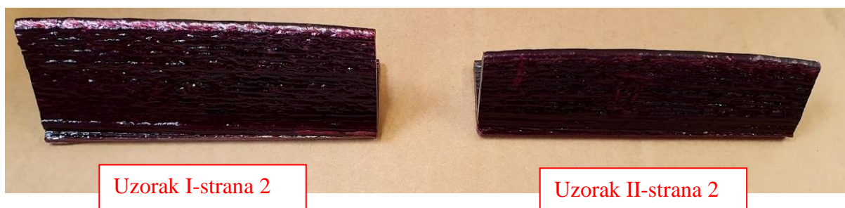
Slika 43. Strane 2 uzoraka nakon nanošenja penetranta
