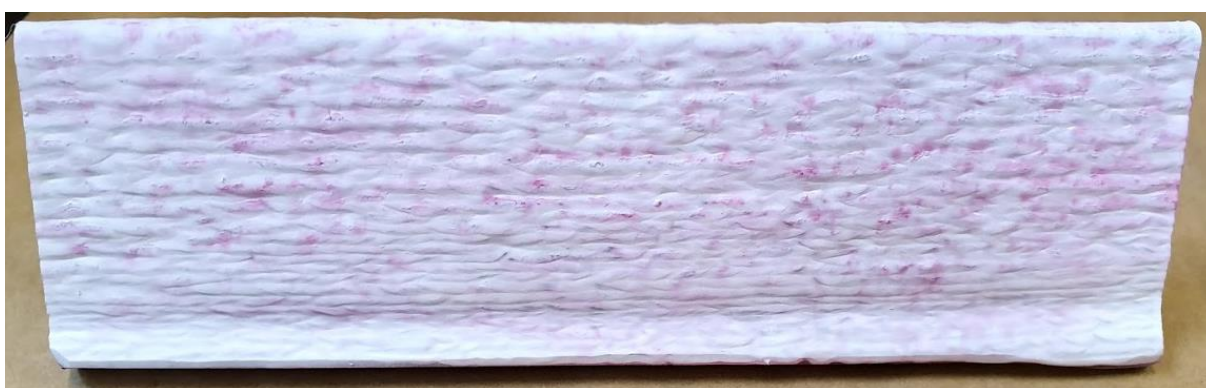
Slika 46. Rezultati penetrantske metode na strani 2 uzorka II
