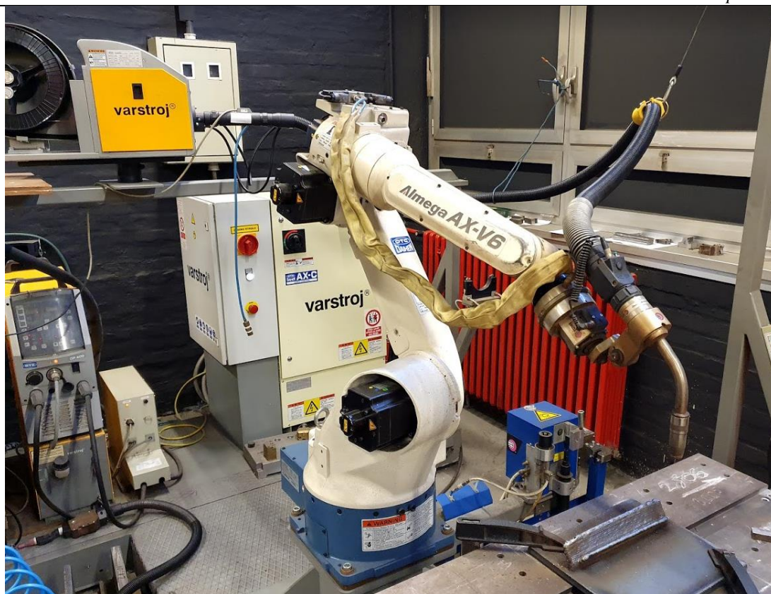
Slika 20. Stanica za zavarivanje Almega OTC AX V6
