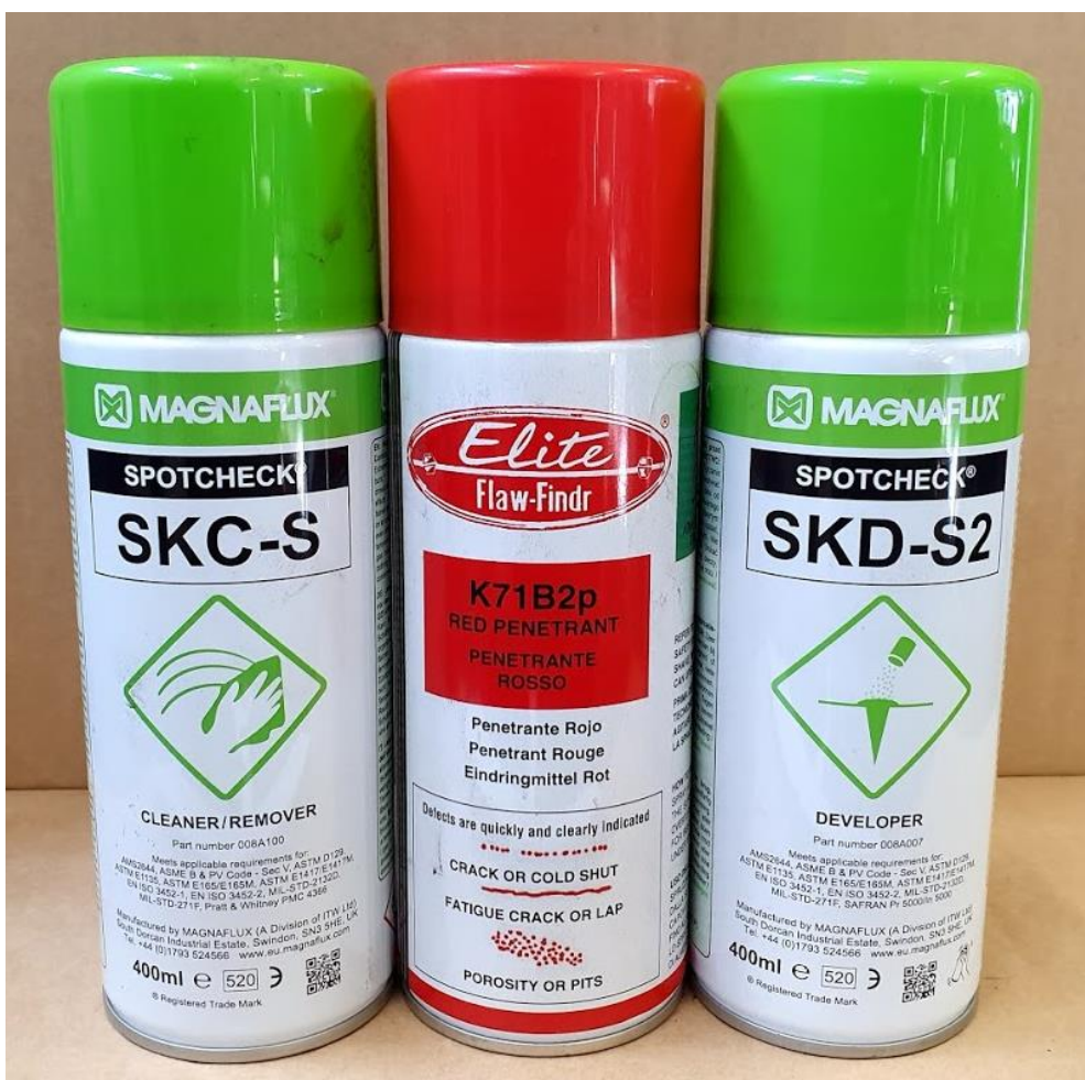
Slika 41. Sredstva korištena za penetrantsko ispitivanje
