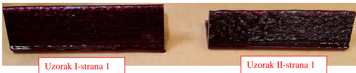
Slika 44. Strana 1 nakon nanošenja penetranta
