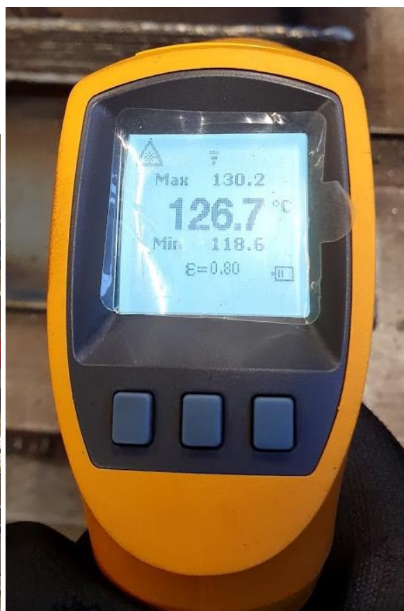
Slika 24. Infracrveni digitalni termometar korišten u eksperimentu
