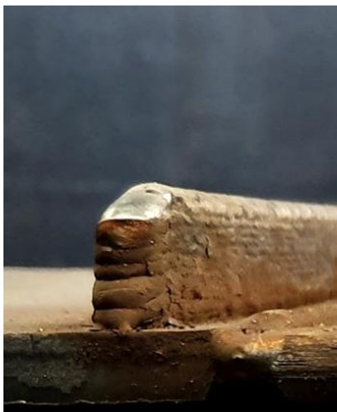
Slika 26. Izgled pripremljene podloge sa zidom
