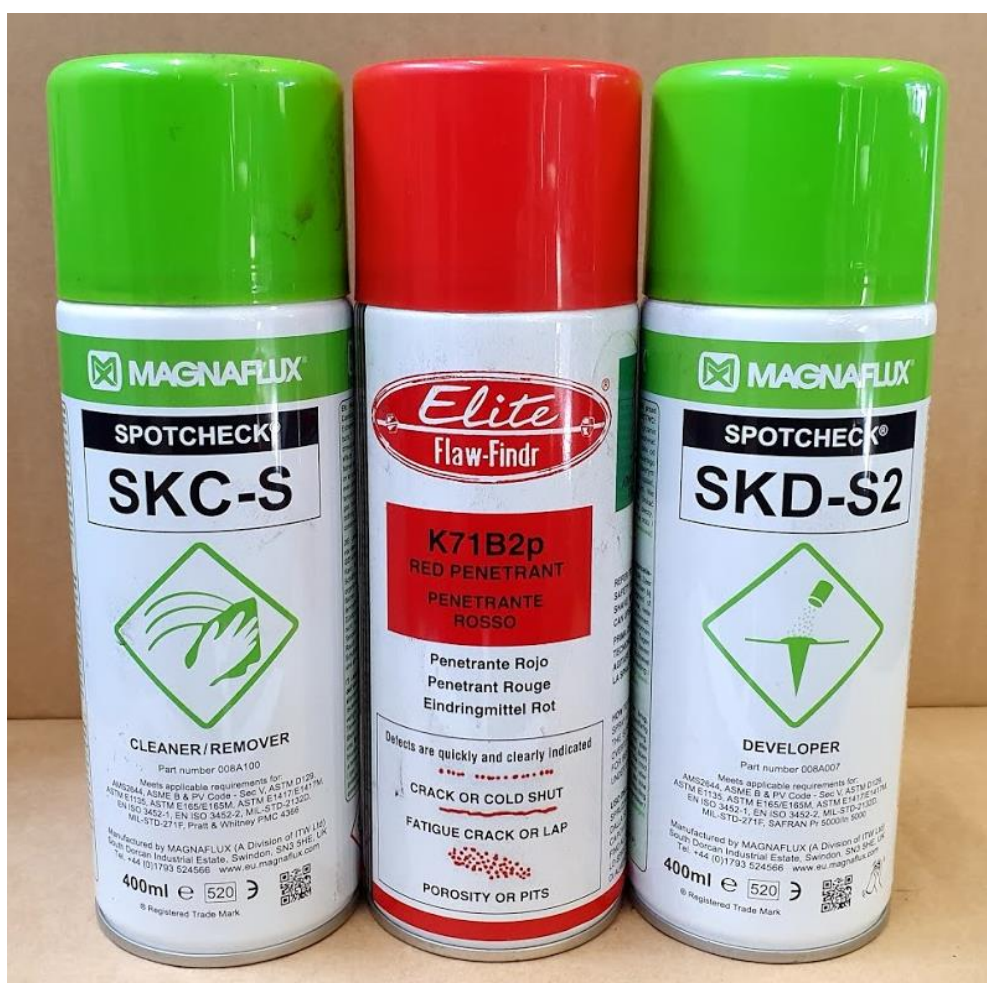
Slika 41. Sredstva korištena za penetrantsko ispitivanje
