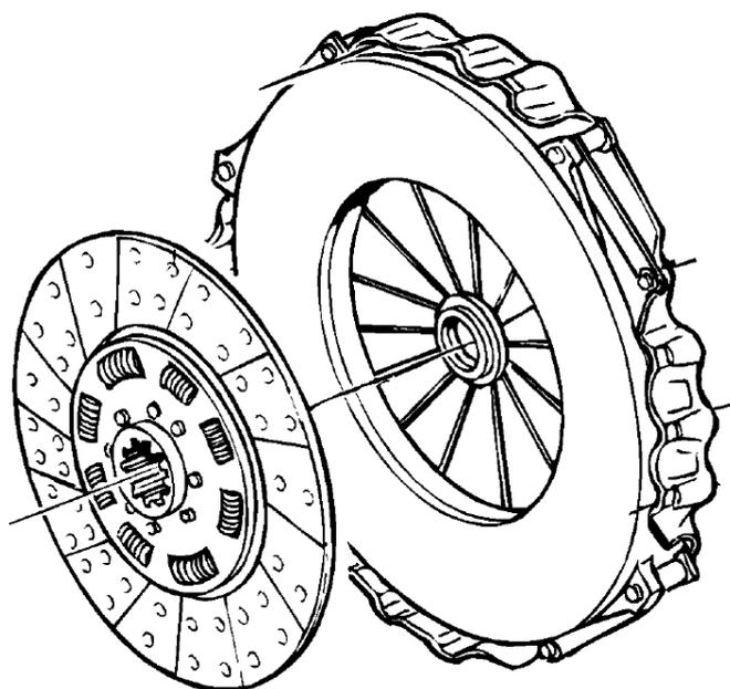
Slika 2.5. Lamela i potisna ploča spojke [4].
