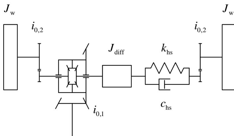
Slika 3.22. Kinematska shema pogonske osovine.
