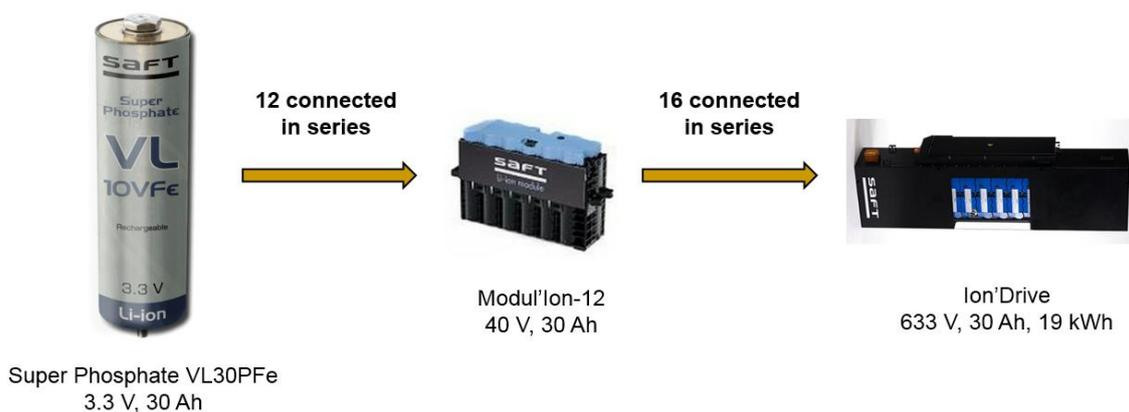
Slika 2.7. Ilustracija strukture baterijskog paketa Volvo 7900 PHEV autobusa.
