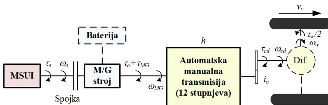
Slika 2.1. Konfiguracija pogona PHEV-a paralelne P2 konfiguracije [8].
