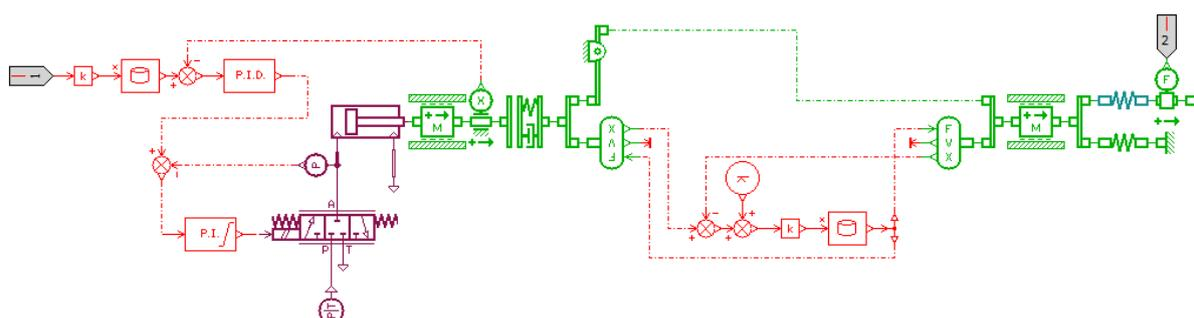
Slika 3.20. Model pneumatskog aktuatora s aksijalnom dinamikom spojke.
