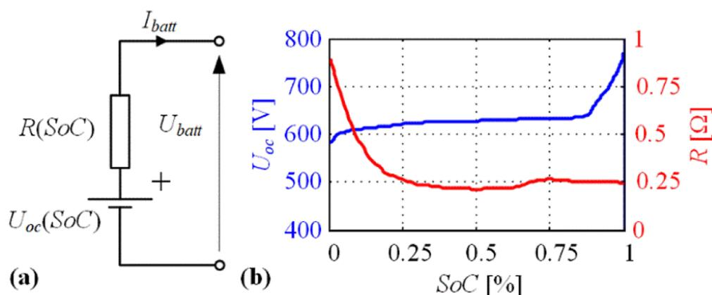
Slika 3.13. Nadomjesni električni krug baterijskog paketa (a) i karakteristike napona otvorenog kruga i unutarnjeg otpora u ovisnosti o Soc-u (b) [8].
