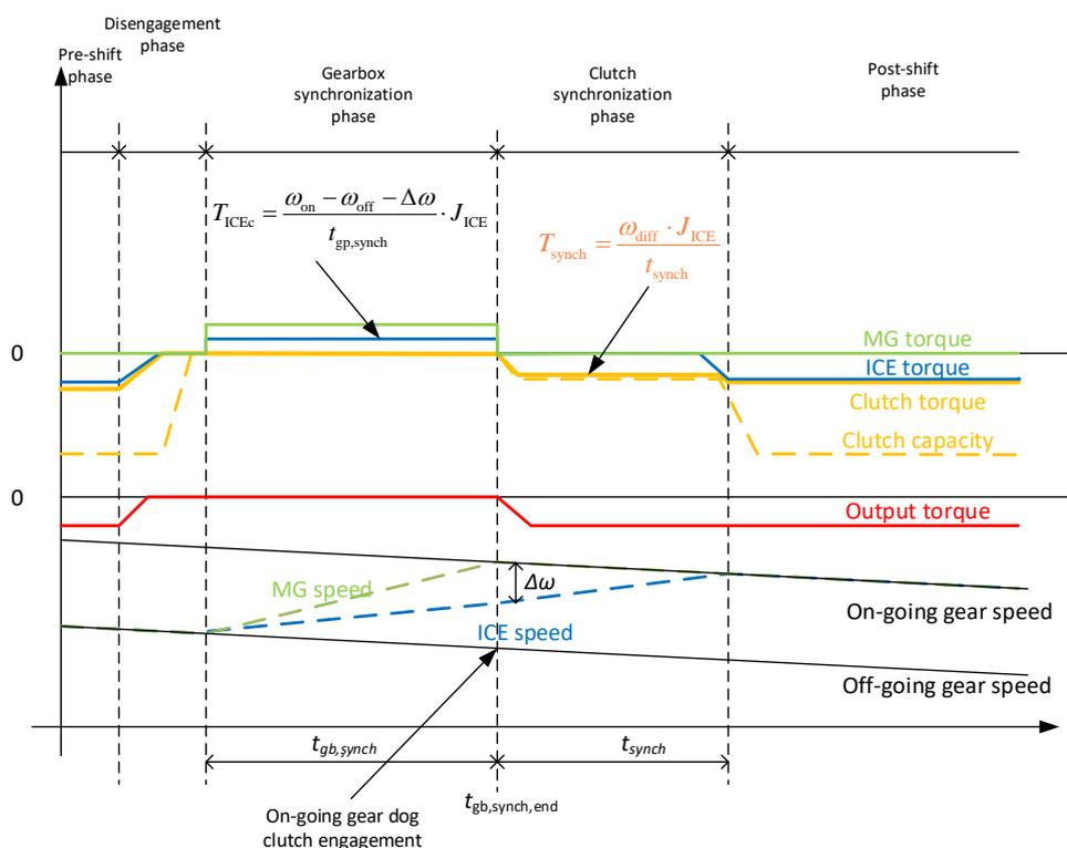
Slika 4.4. Ilustracija idealizirane silazne promjene stupnja prijenosa bez snage.
