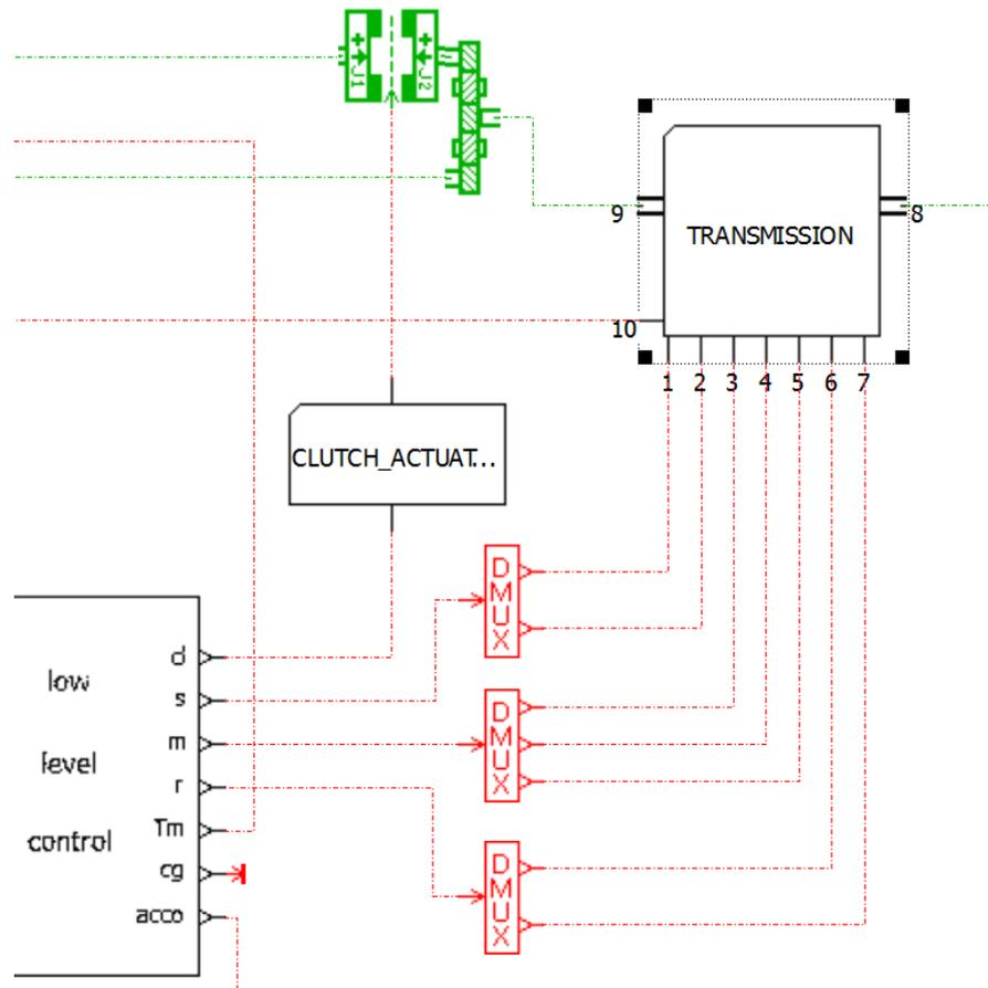
**Slika 3.14. Veze podmdela transmisije s ostatkom pogona.**
