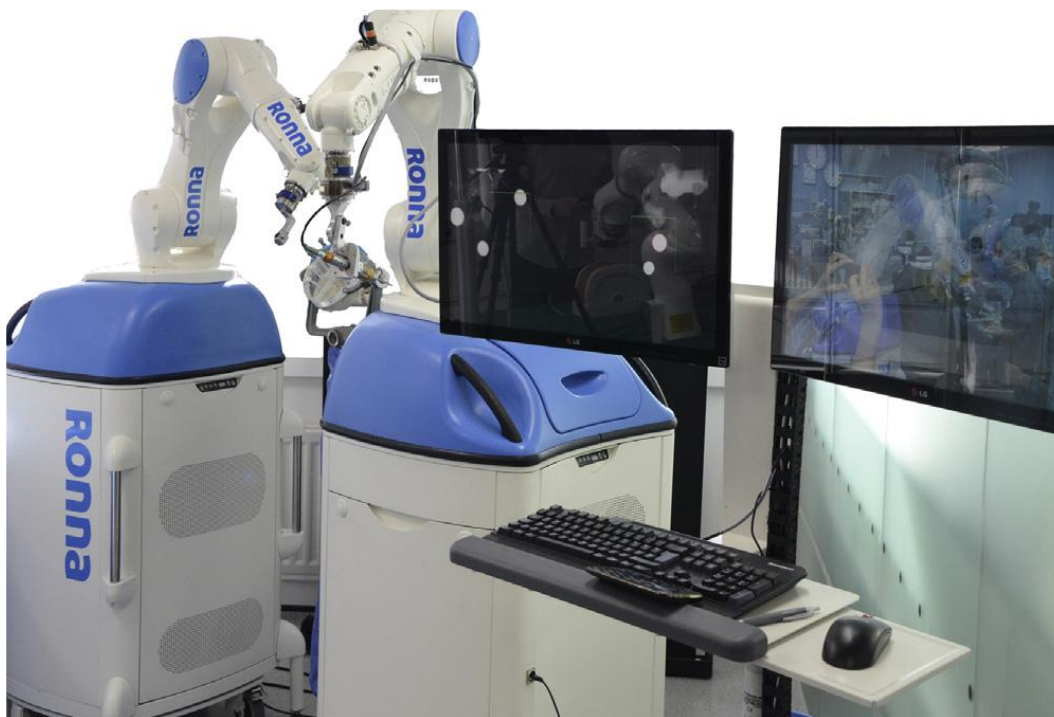
Slika 12. Trenutna verzija RONNA G4 sustava u dvoručnoj konfiguraciji
