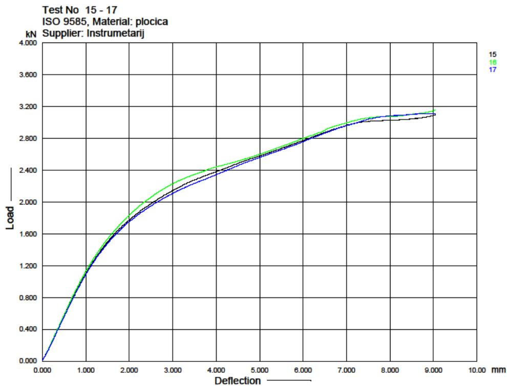
Slika 5.13. Dijagram sila-progib za koso ožljebljenu pločicu
