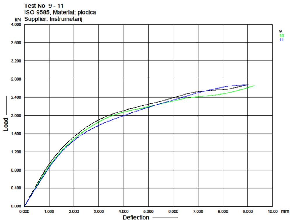
Slika 5.11. Dijagram sila-progib za poprečno ožljebljenu pločicu
