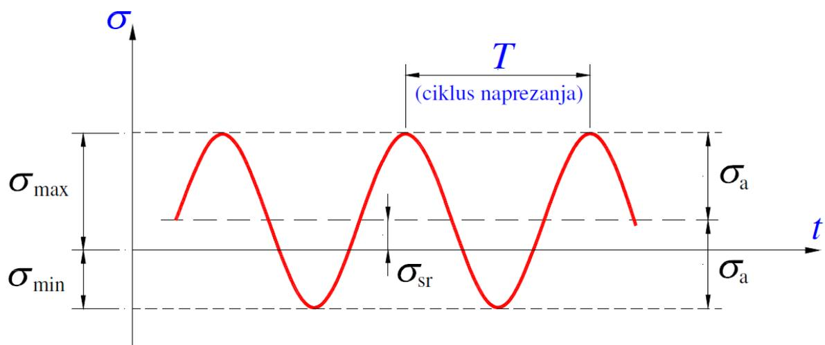
Slika 3.6. Karakteristična naprezanja pri sinusoidalnom opterećenju
