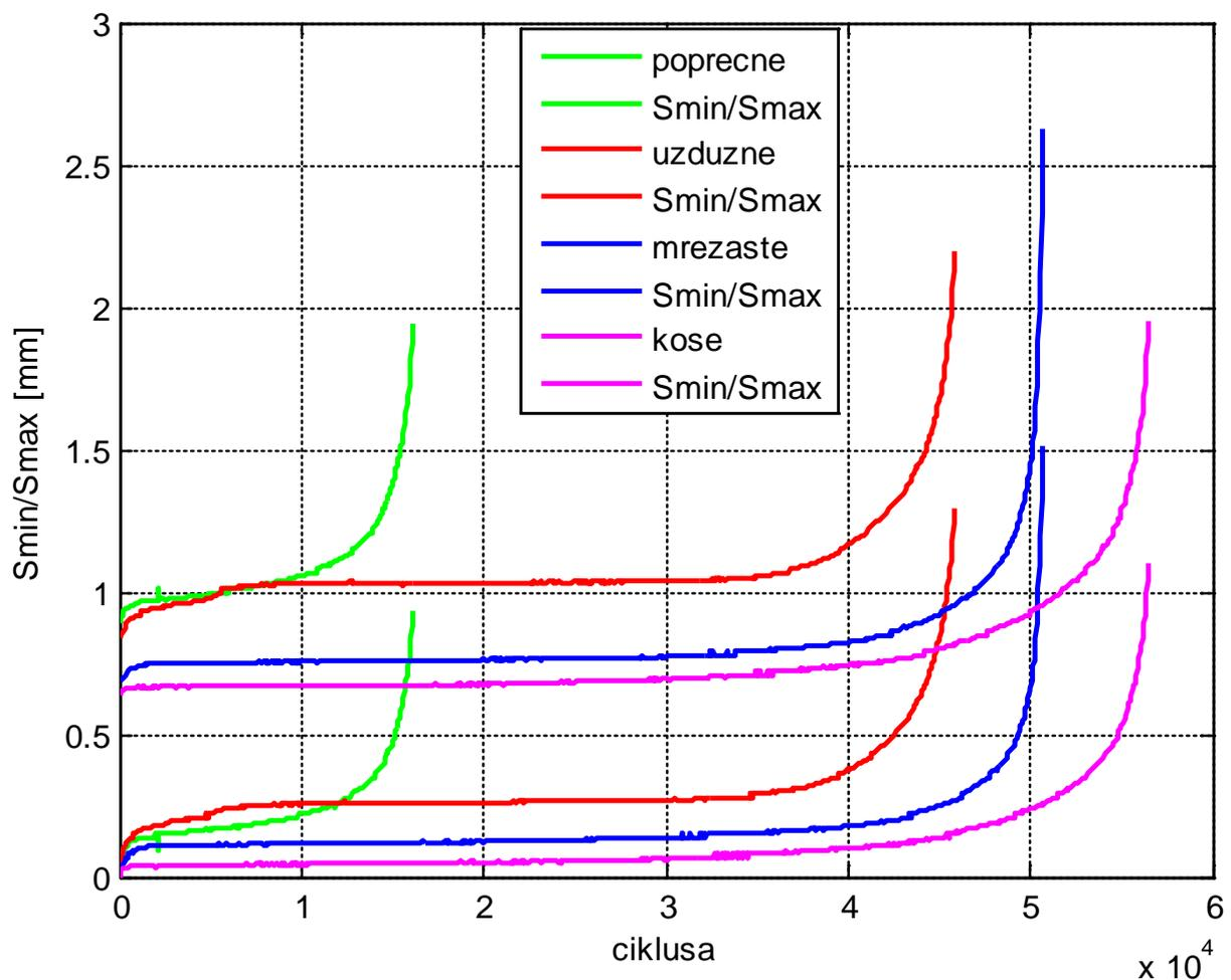
5.25. Ukupni rezultati dinamičkog ispitivanja pločica s ožljebljenom kontaktnom površinom
