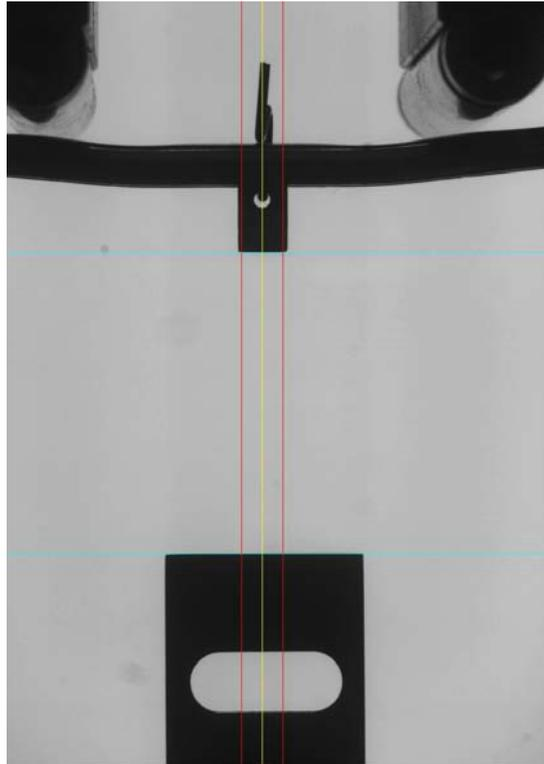
*Slika 5.6 . Mjerenje progiba pločice*
