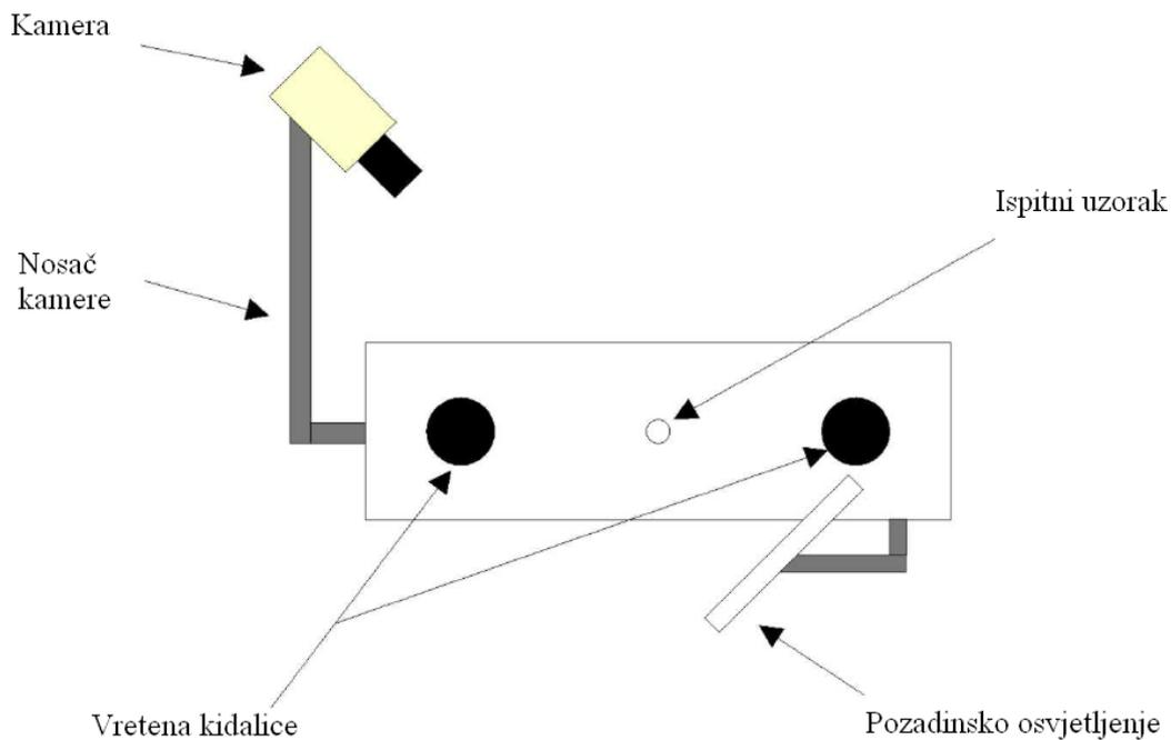
*Slika 5.2. Postav mjernih uređaja tijekom provedbe mjerenja progiba*
