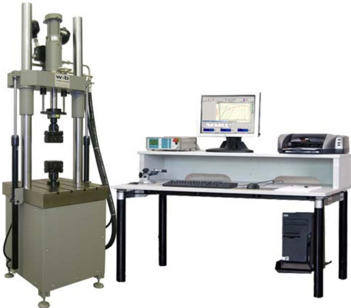
*Slika 5.16. Servohidraulička kidalica LFV 50-HH s upravljačkom jedinicom*
