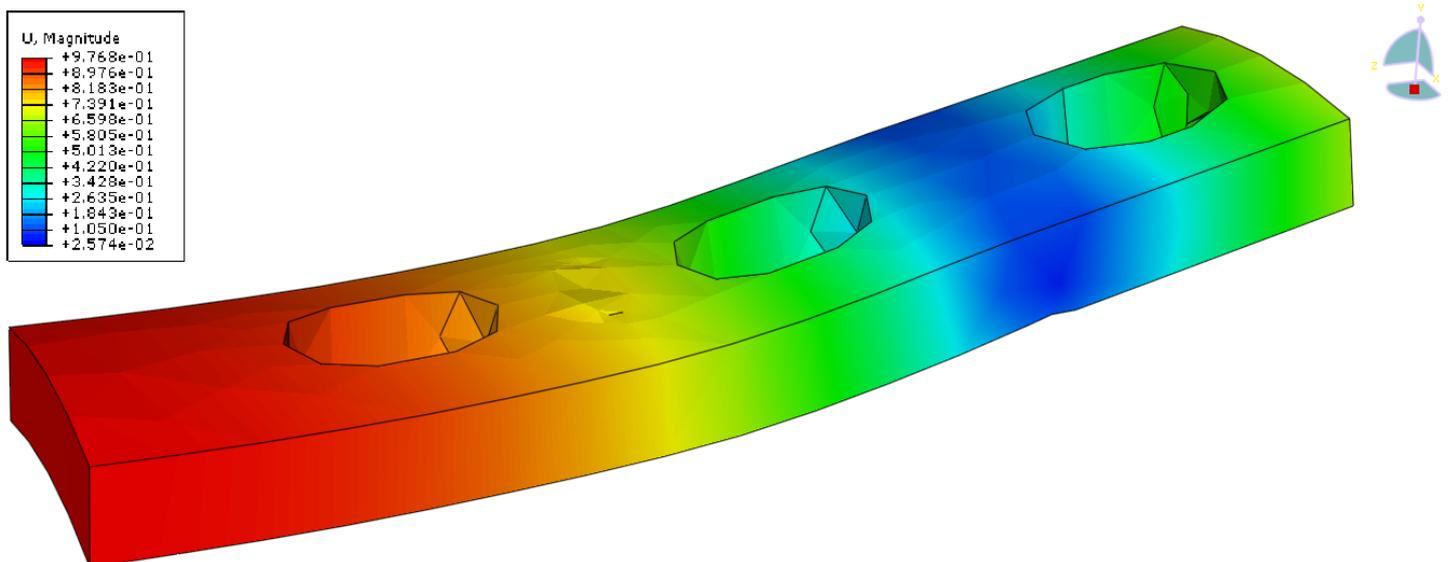
Slika 6.8. Vertikalni pomaci pločice
