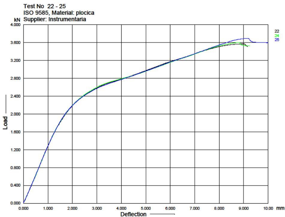
Slika 5.14. Dijagram sila-progib za glatku pločicu
