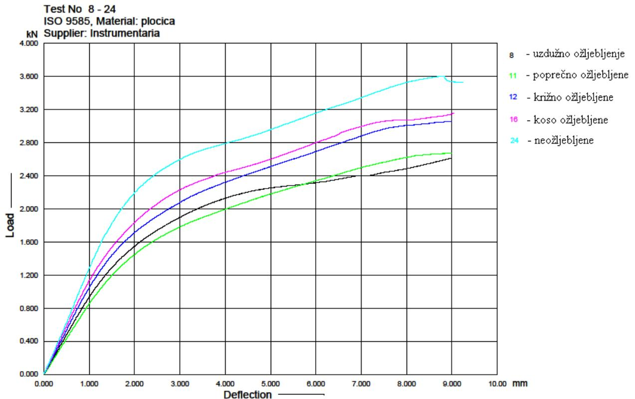
Slika 5.15. Dijagram sila-progib za sve vrste ispitivanih pločica
