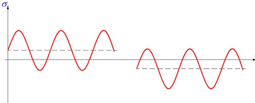
*Slika 3.8. Sinusni oblik izmjeničnog promjenjivog naprežanja*
