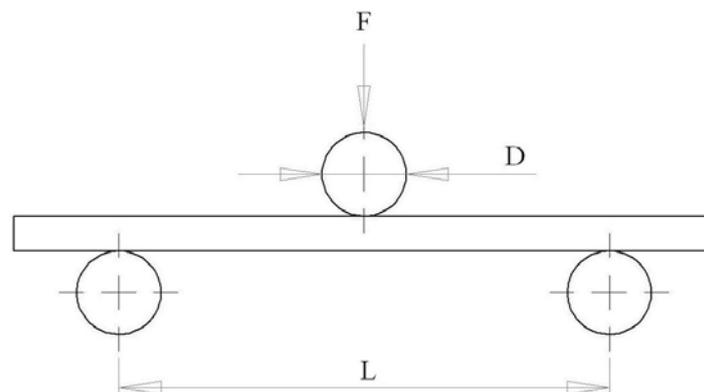
Slika 3.3. Test savijanja u 3 točke
