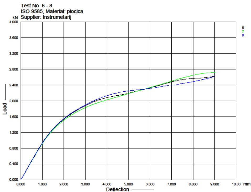
*Slika 5.10. Dijagram sila-progib za uzdužno ožljebljenu pločicu*
