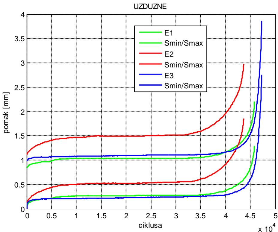
Slika 5.20. Uzdužno ožljebljene pločice
