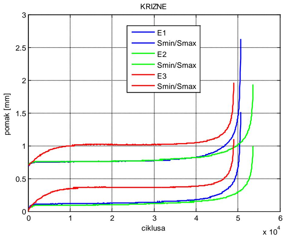
Slika 5.23. Križno ožljebljene pločice
