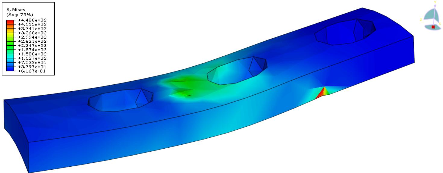
Slika 6.7. Raspodjela naprezanja u pločici
