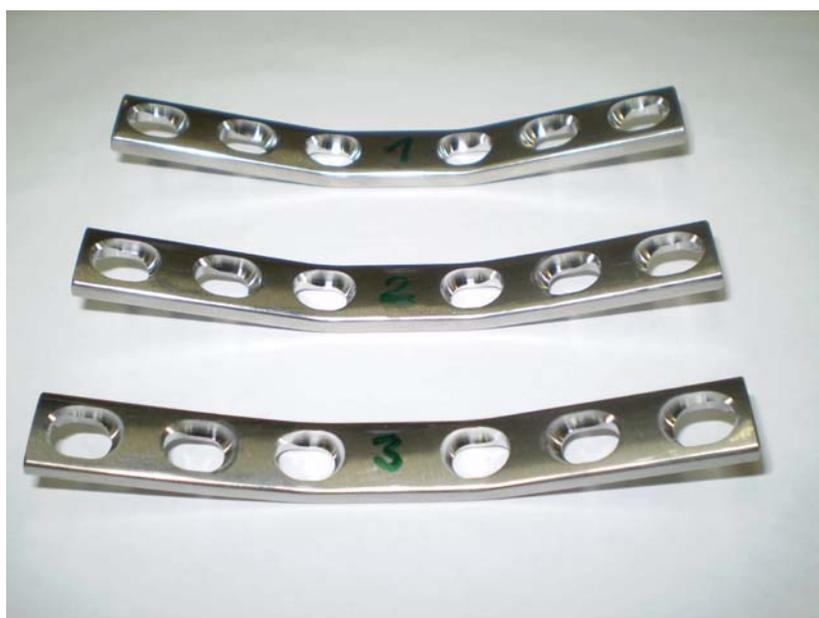
Slika 5.9. Pločice nakon ispitivanja
