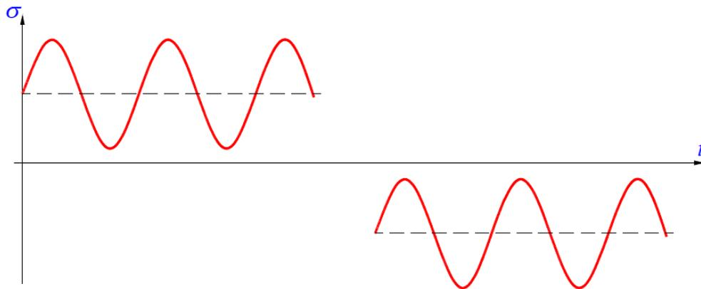
*Slika 3.7. Sinusni oblik istosmjernog promjenjivog naprežanja*
