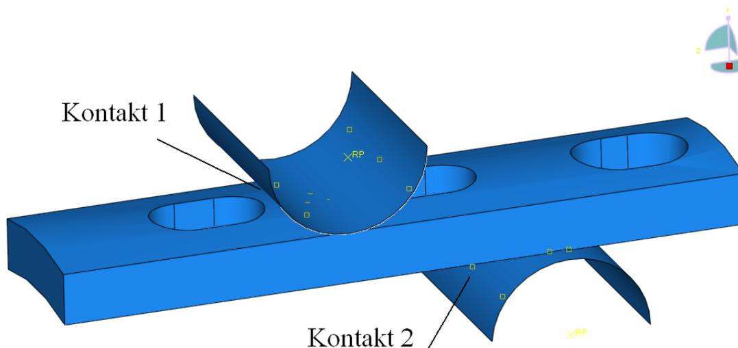
Slika 6.5. Kontaktne površine
