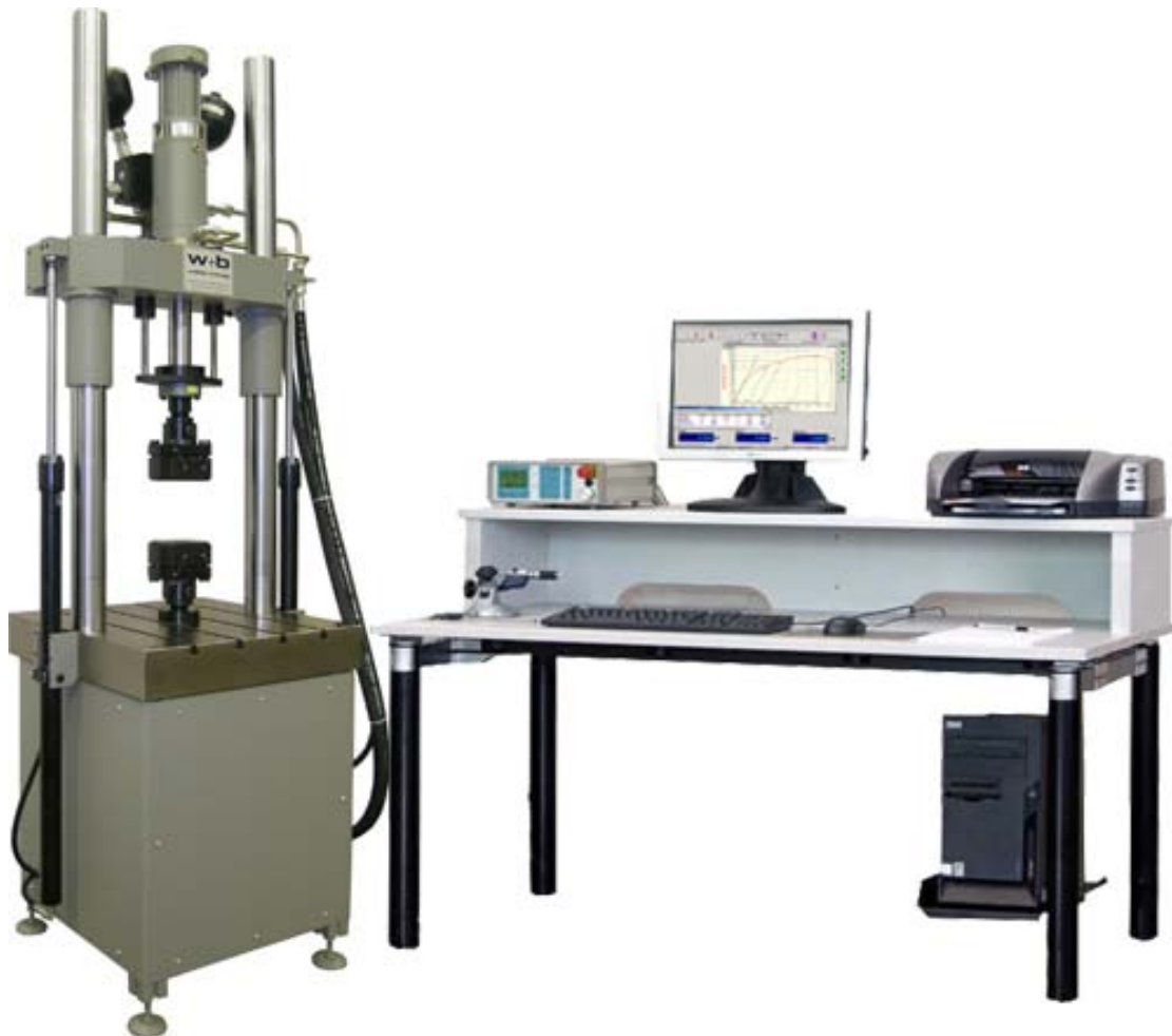
Slika 5.16. Servohidraulička kidalica LFV 50-HH s upravljačkom jedinicom
