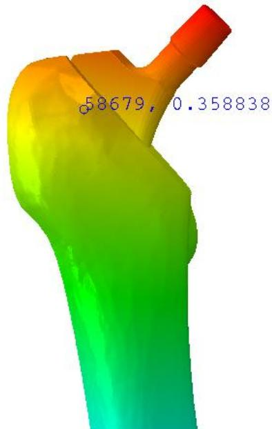
**Slika 56. Apsolutni pomak odabrane točke modela TCC****Tablica 10. Vrijednosti pomaka odabrane točke modela TCC**
