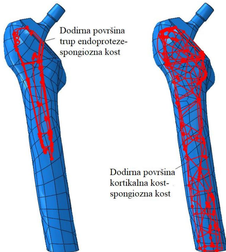
**Slika 39. Veze između dodirnih površina kod računalnih modela**
