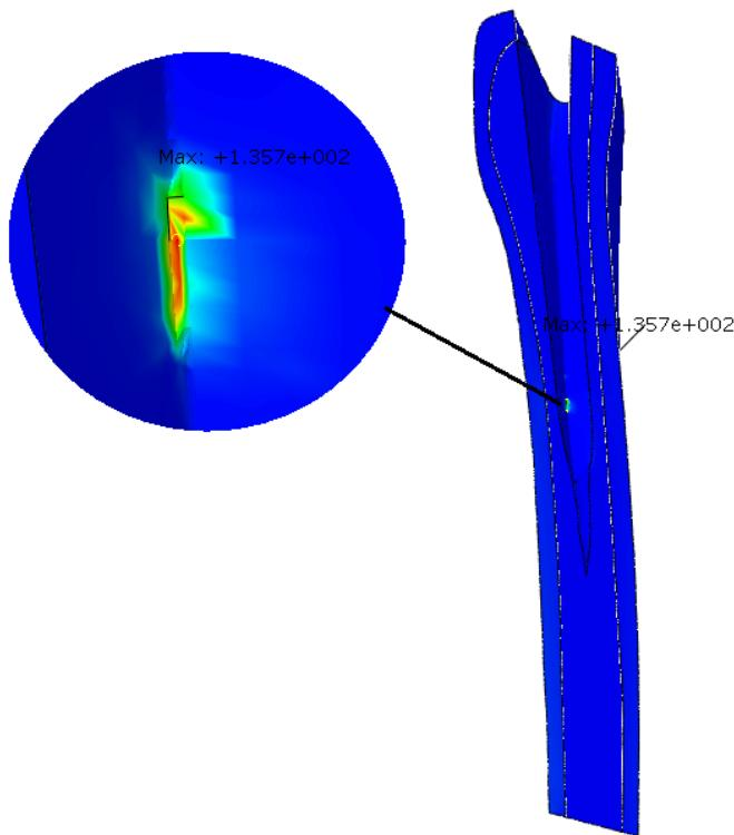
Slika 61. Kontaktna naprezanja na modelu TCA (model 1)
