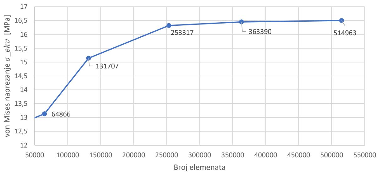
**Slika 43. Dijagram konvergencije za von Mises naprezanje**
