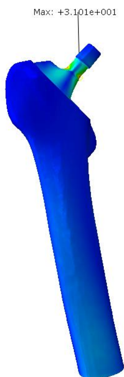
Slika 62. Naprezanja na modelu TCA
