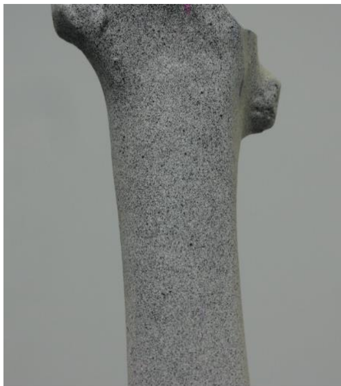
Slika 25. Stohastički uzorak na ispitnom modelu
