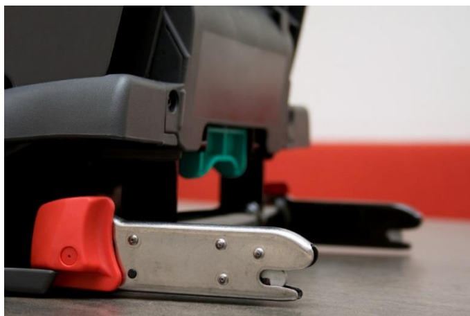
Slika 18 Isofix sustav pričvršćivanja dječjih autosjedalica [15]
