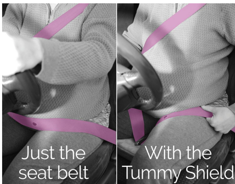
Slika 13 Način pozicioniranja sigurnosnog pojasa [9]
