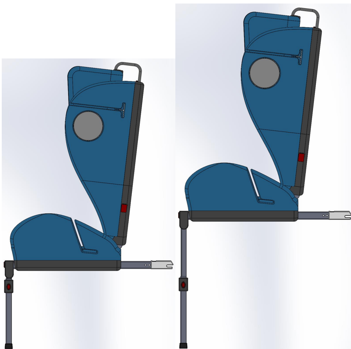
Slika 47 Prikaz podešavanja potporne noge
