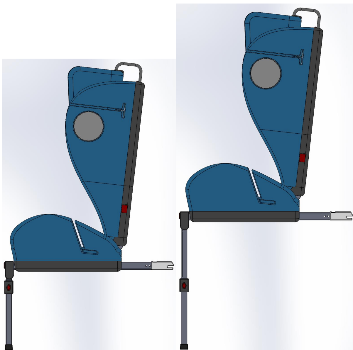
Slika 47 Prikaz podešavanja potporne noge
