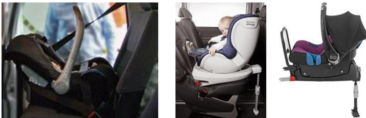
Slika 14 Prikaz dječjih autosjedalica s postavljanjem suprotno smjeru vožnje: a) vezanje pojasmom, b) vezanje uz pomoć Isofixa, c) Isofix baza [10]
