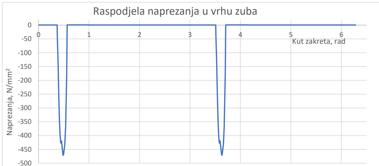
Slika 44. Graf raspodjele tlačnih napreznja u vrhu zuba
