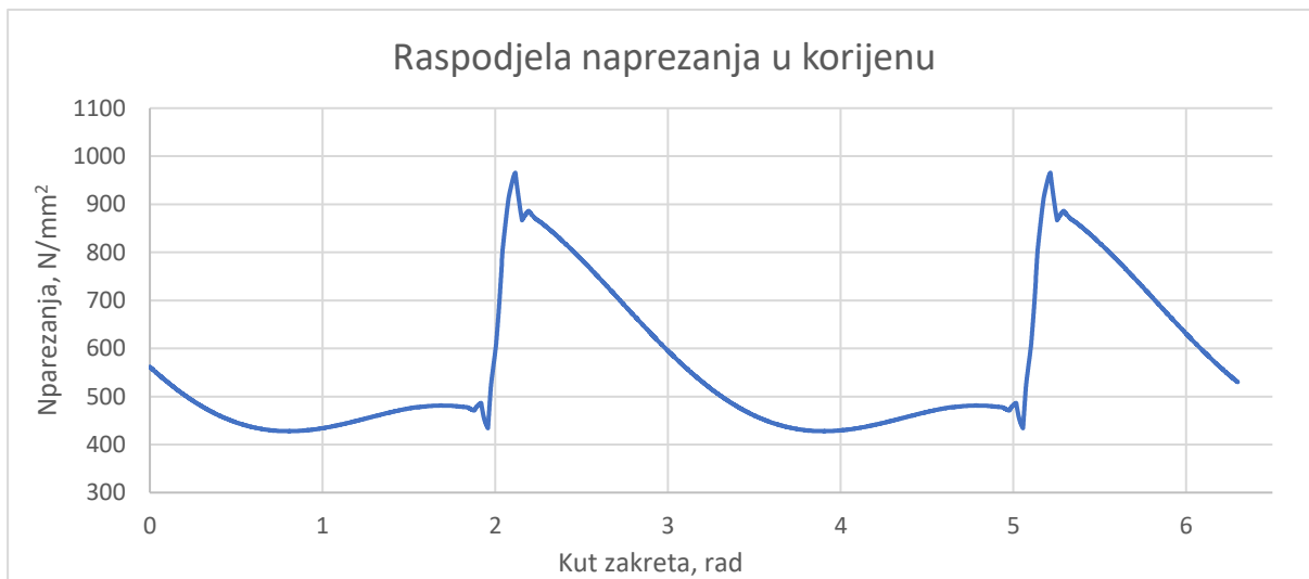
Slika 42. Graf raspodjele vlačnih naprezanja u korijenu zuba
