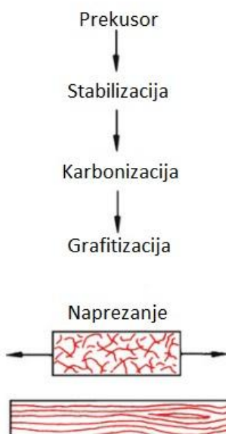
Slika 10. Shematski prikaz proizvodnje ugljičnih vlakana na bazi umjetne svile
